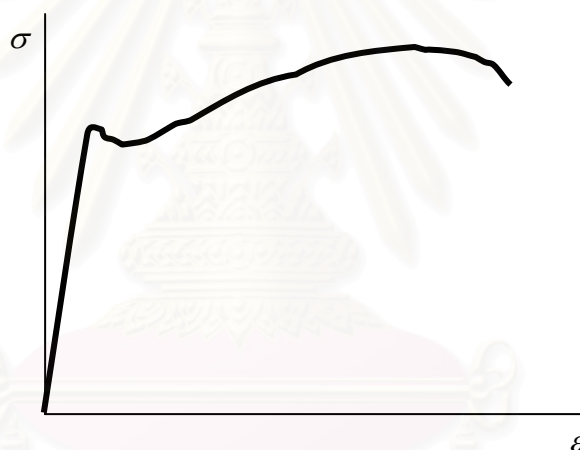
รูปที่ 2.4 แผนภาพความสัมพันธ์ระหว่างค่าความเค้นและค่าความเครียด
