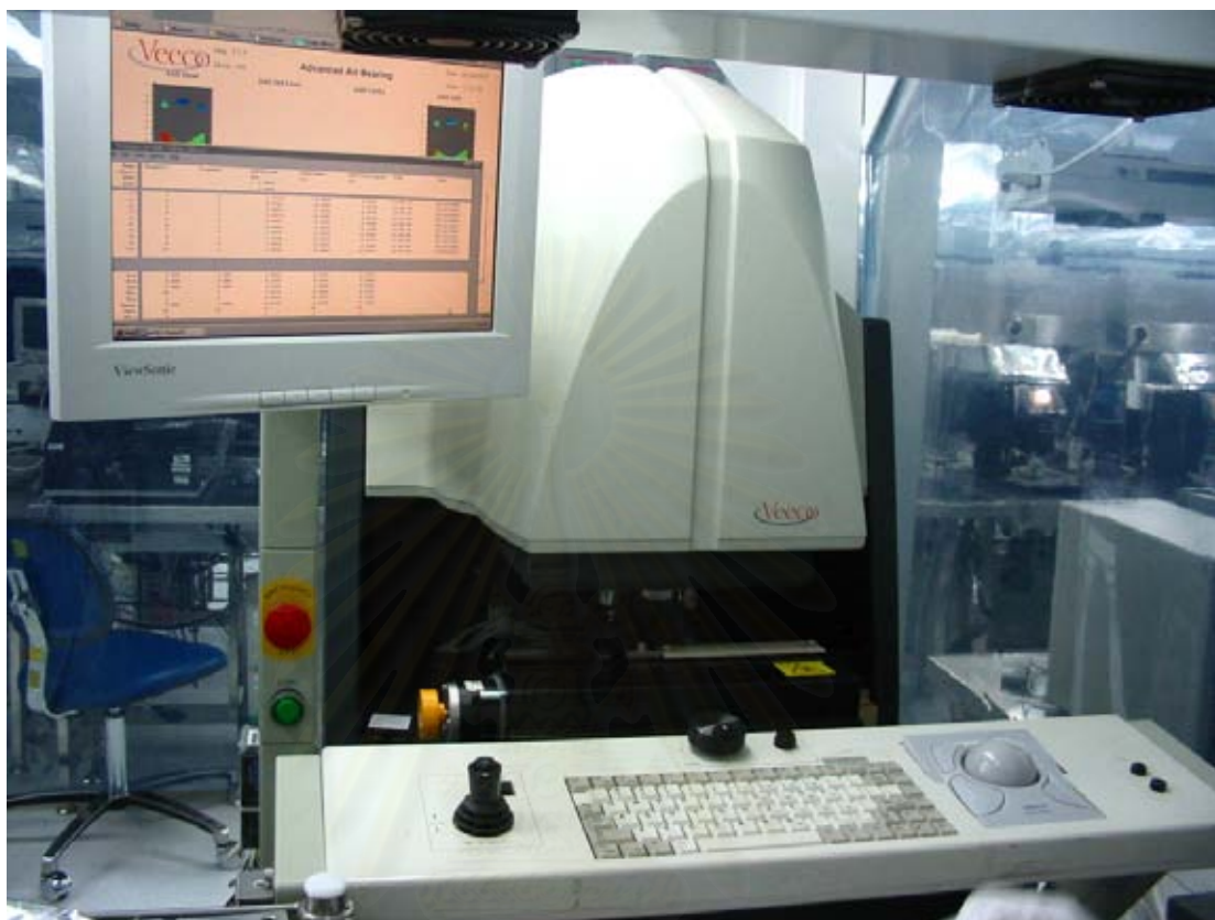
รูปที่ 4.6 เครื่อง WYKO HD3300 ใช้สำหรับการวัดค่าการโก่งตัวของตัวหัวเขียนอ่านข้อมูล
