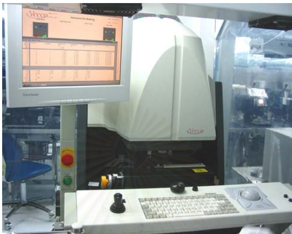
รูปที่ ก9 เครื่อง WYKO HD3300 สำหรับวัดค่าการโก่งตัวของตัวหัวเขียนอ่านข้อมูล
