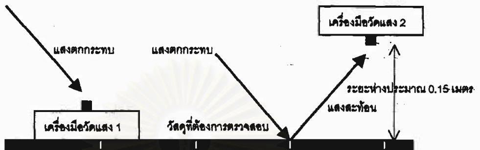
รูปที่ 1.3 รูปแสดงการวัดค่าการสะท้อนแสงของวัสดุ (คมกฤษ ฐเกียรติมัน, 2540:5)
