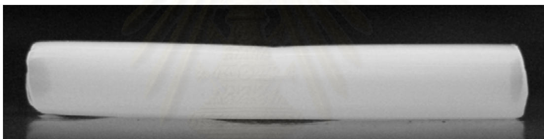
รูปที่ 4.12 รอยหักของท่อโพลีเอทีลีน/เอทีลีนไวนิลอะซิเตต ซึ่งมีเอทีลีนไวนิลอะซิเตต 20 % (18 % ไวนิลอะซิเตต)
