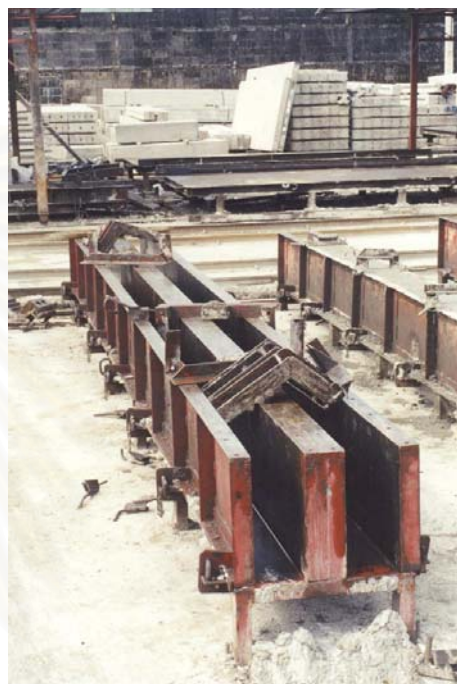
รูปที่ 5-8 แสดงโรงงานในส่วนของงาน หล่อแบบชิ้นส่วนคอคตกรีต
