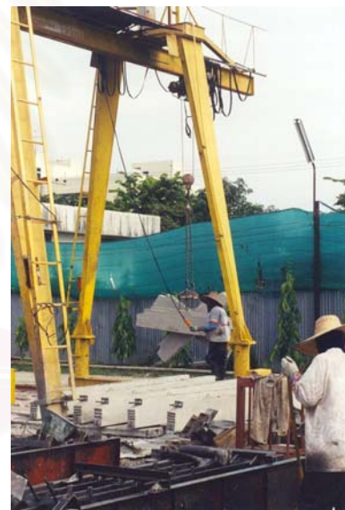
รูปที่ 5-13 แสดงการทำปลาสเตอร์ผิว และการยกชิ้นส่วนที่หล่อเสร็จแล้วไปเก็บด้วย Portal cranes
