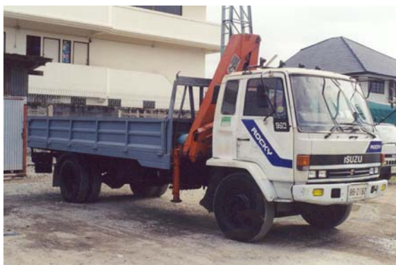
รูปที่ 5-15 แสดงรถเครนที่ขนส่งชิ้นส่วนสำเร็จรูป
