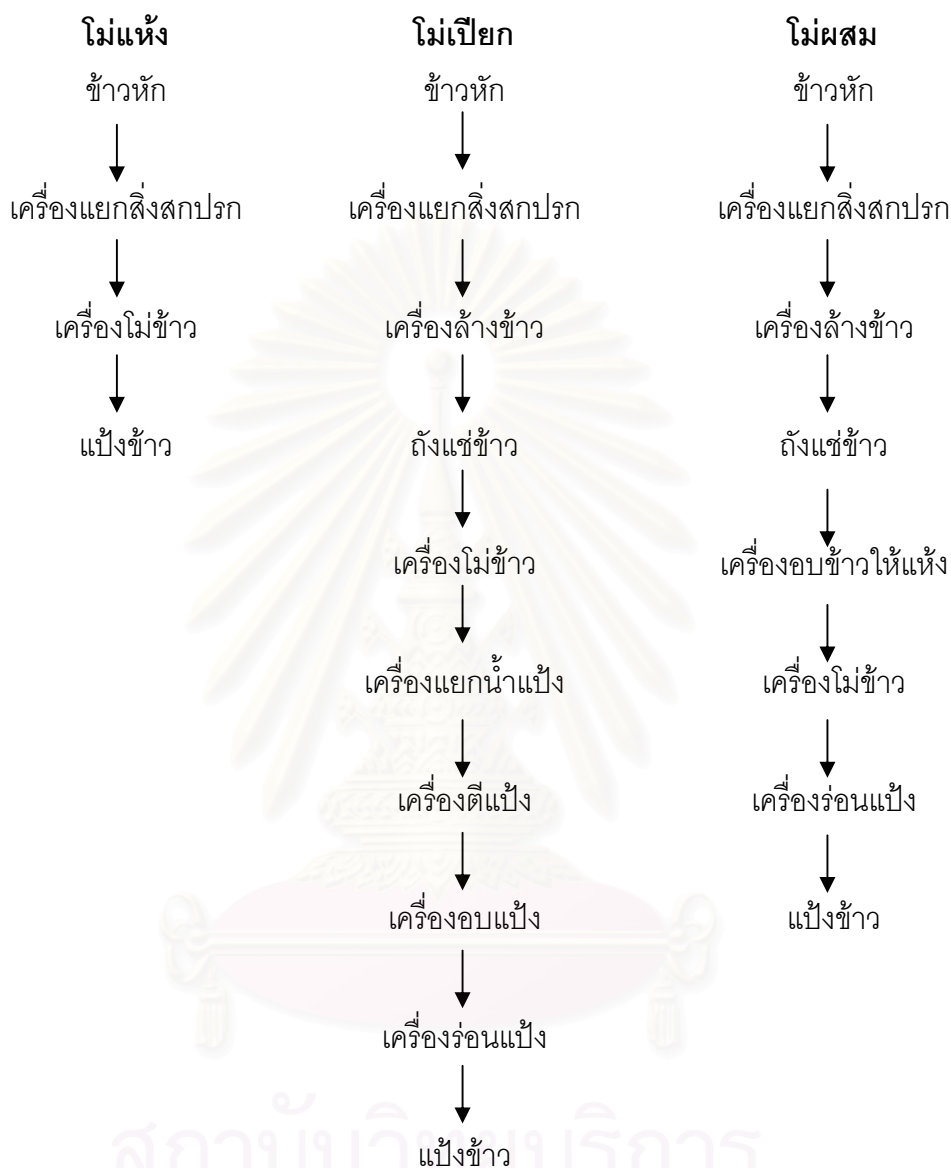
รูปที่ 2.5 วิธีโม่ข้าวแบบแห้ง เปียก และผสม
