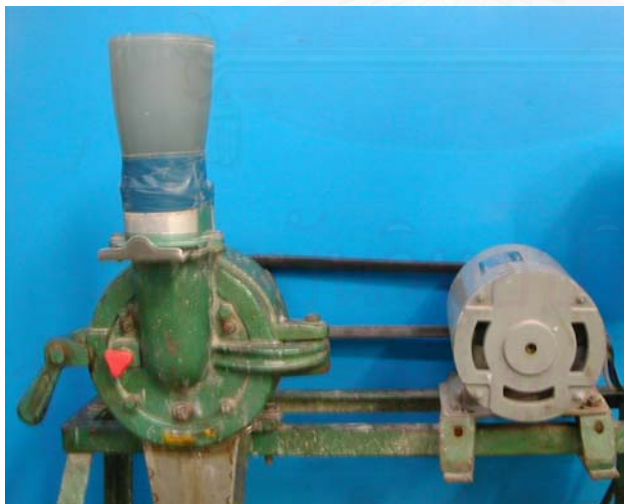
ภาพที่ ข.2 เครื่องโม่หิน (Stone mill) ประเภท single disc mill
