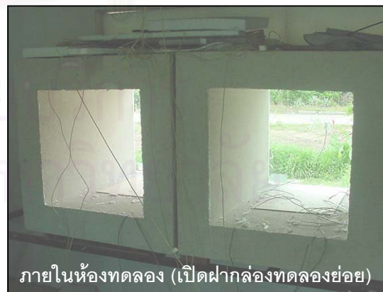
รูปที่ 4.1 แสดงการทดสอบพฤติกรรมการถ่ายเทความร้อนผ่านช่องแสงกระจก (ปรับอากาศ)
