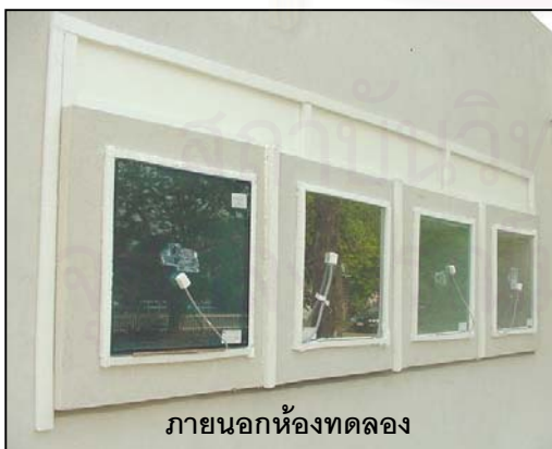
รูปที่ 4.1 แสดงการทดสอบพฤติกรรมการถ่ายเทความร้อนผ่านช่องแสงกระจก (ปรับอากาศ)
