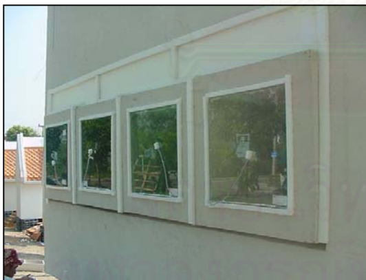
รูปที่ 4.3 แสดงการทดสอบพฤติกรรมการถ่ายเทความร้อนผ่านช่องแสงกระจกด้านข้างในทิศ 4 ทิศ
