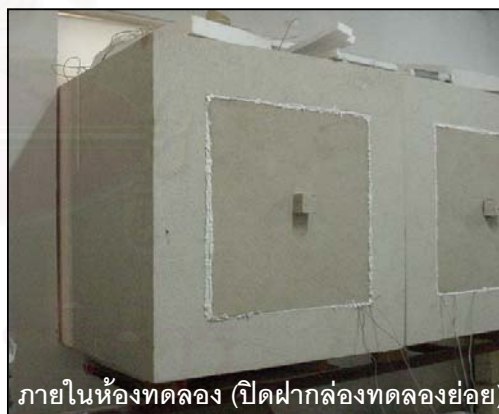
รูปที่ 4.2 แสดงการทดสอบพฤติกรรมการถ่ายเทความร้อนผ่านช่องแสงกระจก (ไม่ปรับอากาศ)
