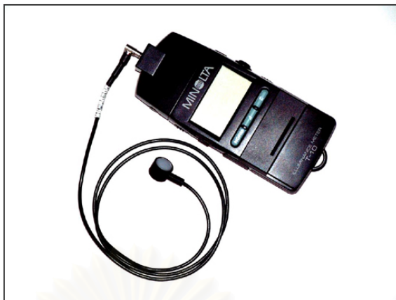
รูปที่ 3.9 แสดงเครื่องมือที่วัดปริมาณแสงสว่าง Illumination Meter (Minolta T -10)
