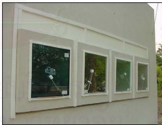
รูปที่ 4.3 แสดงการทดสอบพฤติกรรมการถ่ายเทความร้อนผ่านช่องแสงกระจกด้านข้างในทิศ 4 ทิศ
