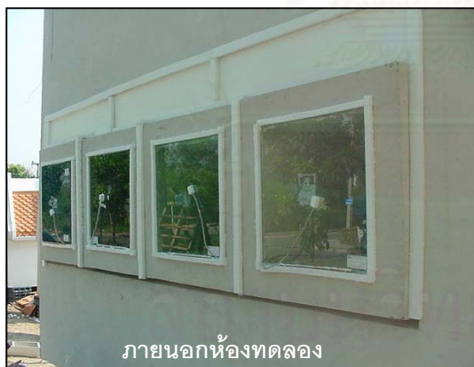
รูปที่ 4.2 แสดงการทดสอบพฤติกรรมการถ่ายเทความร้อนผ่านช่องแสงกระจก (ไม่ปรับอากาศ)
