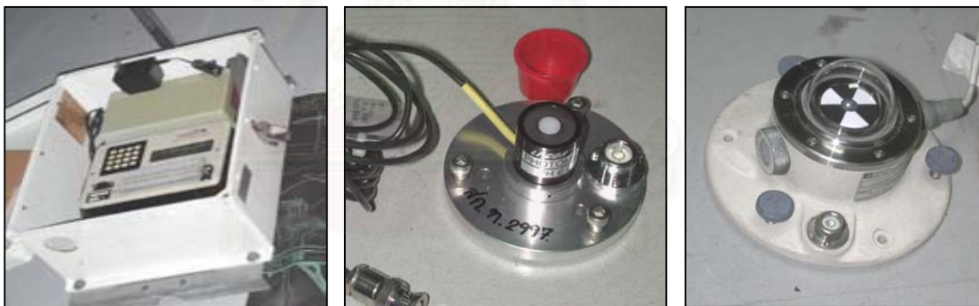
รูปที่ 3.8 แสดง Campbell Data Logger, Photometric Sensor, Pyranometer Sensor ตามลำดับ
