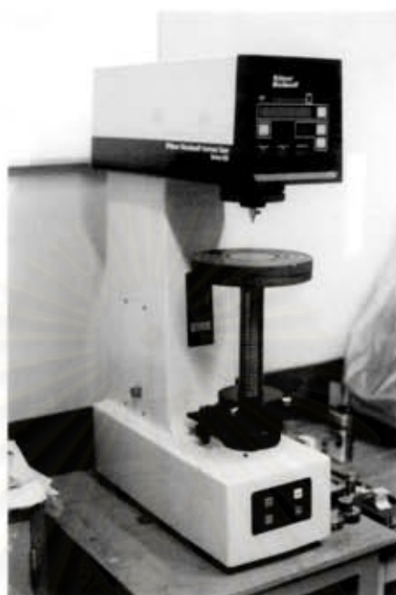
รูปที่ 14 เครื่องวัดความแข็งผิวร็อกเวลล์
