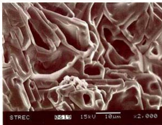
รูปที่ 4.10 แสดงภาพชิ้นงานที่ส่วนผสมผงแป้ง 1% โดยปริมาตร แรงอัดขึ้นรูป 2 MPa เเผที่อุณหภูมิ 1100 องศาเซลเซียส 3 ชั่วโมง รูป(ก) (ข) (ค) ที่กำลังขยาย 200 500 และ 2000 เท่าตามลำดับ
