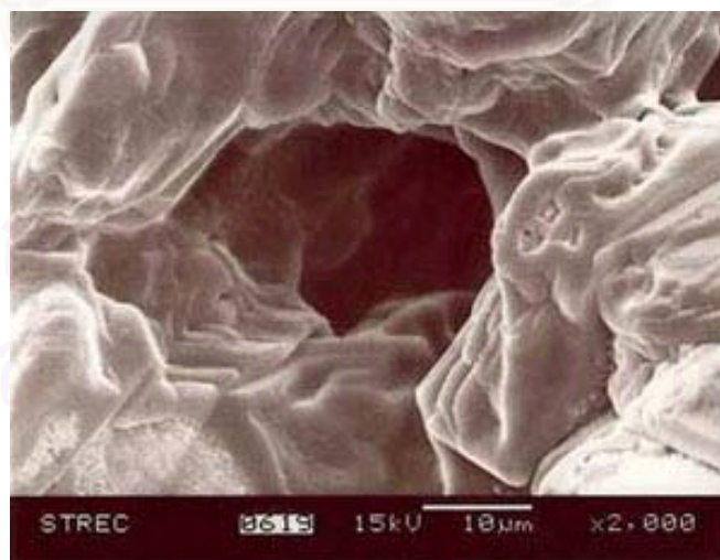
รูปที่ 4.11 แสดงภาพชิ้นงานที่ส่วนผสมผงแป้ง 5% โดยปริมาตร แรงอัดขึ้นรูป 2 MPa เผาที่อุณหภูมิ 1100 องศาเซลเซียส 3 ชั่วโมง รูป(ก) (ข) (ค) ที่กำลังขยาย 200 500 และ 2000 เท่าตามลำดับ
