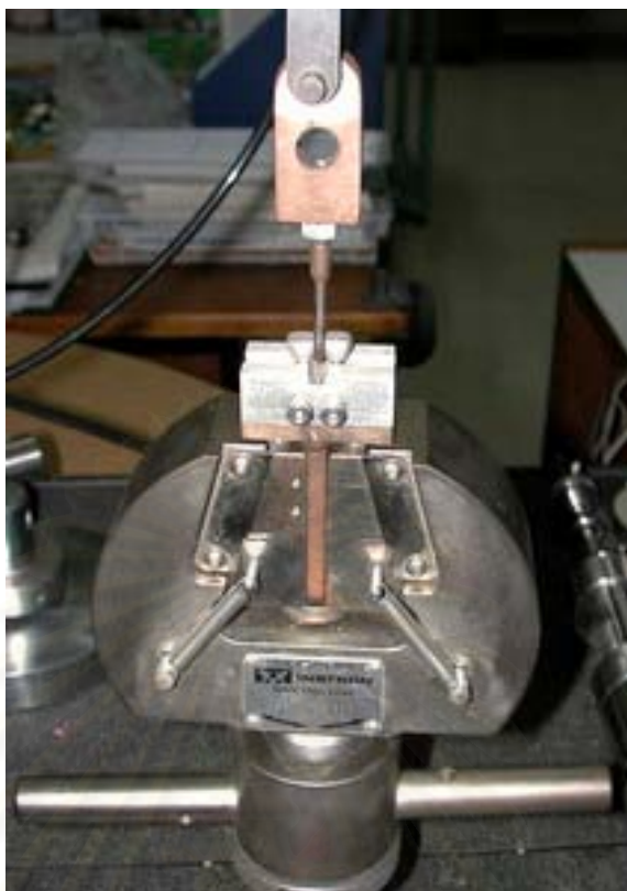
รูปที่32: แสดงการยึดและปรับตำแหน่งการทดสอบให้เข้าที่ก่อนการดึง
