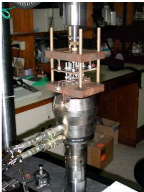
รูปที่ 28: แสดงการยึดเครื่องมือที่ใช้ในการทดสอบเข้ากับเครื่อง Dynamic UTM
