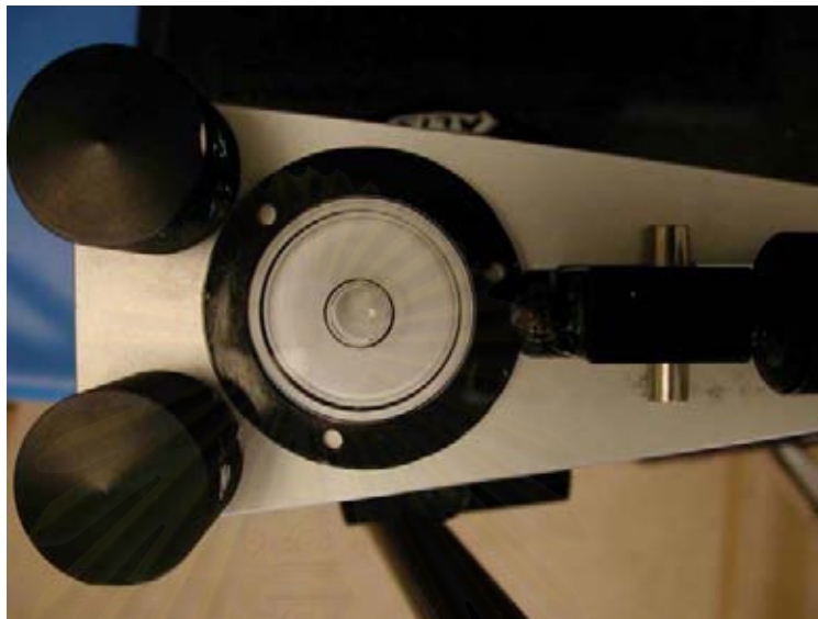
รูปที่17: แสดงการใช้ระดับน้ำเป็นตัวช่วยปรับระดับแท่นยึดแบบหล่อให้ขนานในแนวราบ
