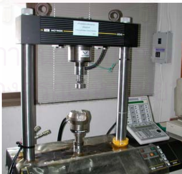
รูปที่26: แสดงเครื่อง Dynamic UTM ในการทดสอบ cyclic loading
