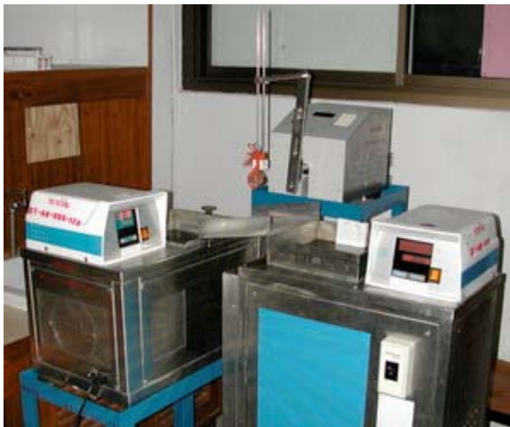
รูปที่25: แสดงชุดเครื่องมือที่ใช้ในการทำ Thermocycling
