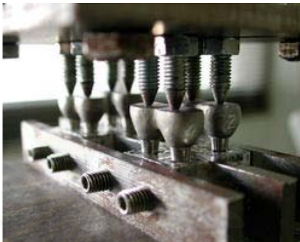
รูปที่ 27: แสดงการนำชิ้นงานไปยึดเข้ากับรางยึด
