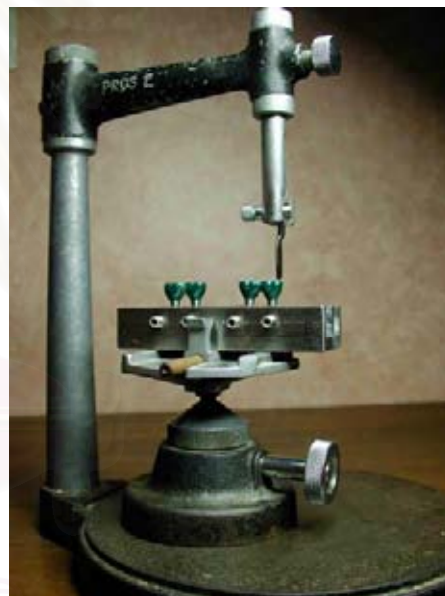
รูปที่19: แสดงการตัดแต่งซี่ผึ้งด้านบนของด้านบดเคี้ยวออกให้เป็นแนวราบขนานกับพื้นโดยทำการแต่งซี่ผึ้งบนเครื่องตรวจสอบความขนาน
