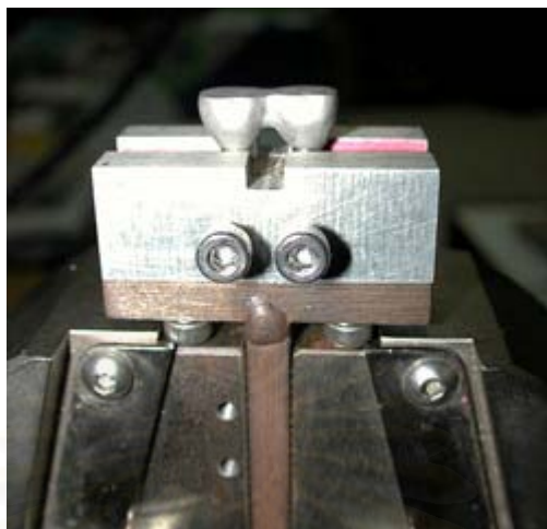
รูปที่30: แสดงการยึดชิ้นทดสอบเข้ากับโครงที่ทำขึ้นมาโดยเฉพาะและยึดกับส่วนล่างของเครื่องทดสอบ
