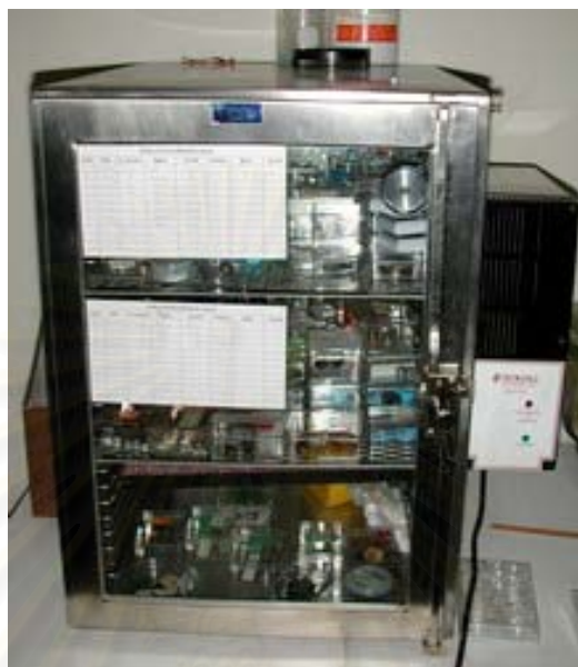
รูปที่34: แสดงเครื่องที่ใช้ในการกำจัดความชื้นของชิ้นทดสอบ
