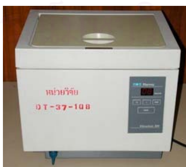
รูปที่33 : แสดงเครื่องทำความสะอาดอัลตราโซนิก
