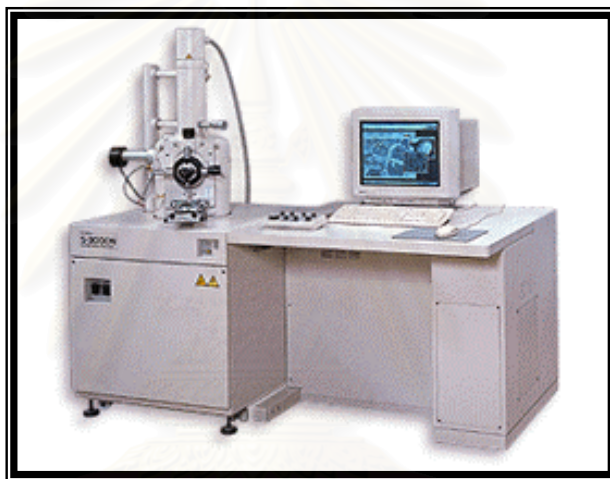
ภาพที่ ก.6 กล้องจุลทรรศน์อิเล็กตรอนแบบส่องกราด
