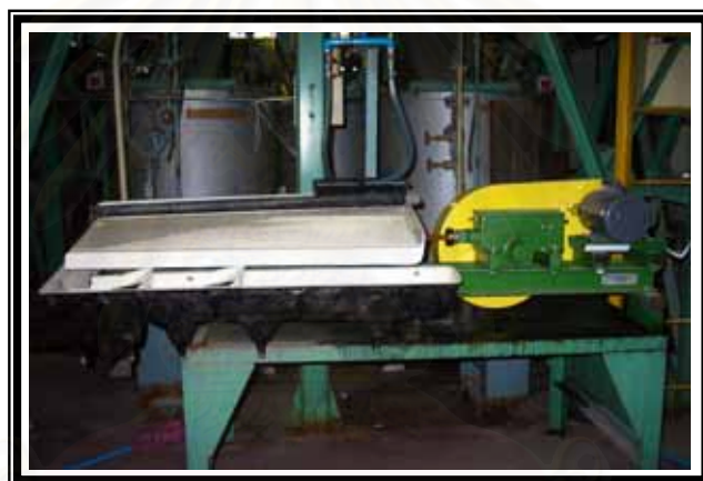
ภาพที่ ก.7 โต๊ะสั่นแยกแร่ (Shaking Table)
