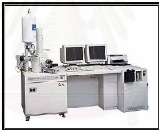
ภาพที่ ก.8 เครื่องเอกซเรย์ชนิดสเปกตรัมเอกซเรย์ (EDX)
