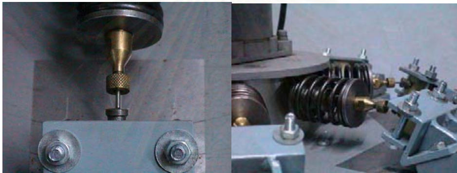
รูปที่ 27 แสดงการถ่ายทอดแรงจากสปริงผ่านหัวกดสู่ครอบฟันที่ยึดกับพื้นหลักบนกล่องอะคริลิก
