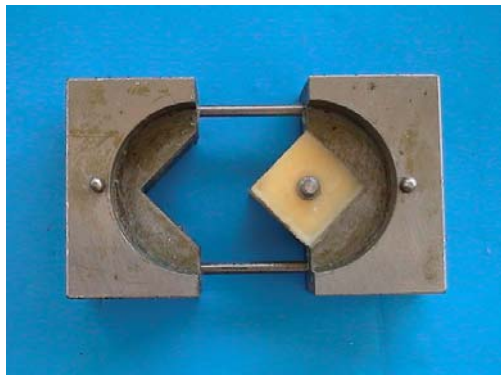
รูปที่ 16 กล่องอะคริลิกที่โพลีเมอร์ไรเซชันสมบูรณ์แล้วสามารถถอดออกได้จากแบบหล่อ
