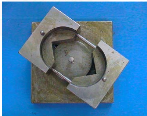
รูปที่ 12 เบ้าโลหะสำหรับหล่อยึดรากเทียมจำลองให้ฝังอยู่ในกล่องอะคริลิก ในลักษณะ ถอดชิ้นส่วนประกอบได้ มีส่วนหัวของฟันหลักรากเทียมจำลองฝังอยู่บริเวณฐาน
