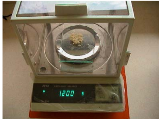
รูปที่ 20 ชั่งปริมาณผงซิงค์ฟอสเฟตซีเมนต์บนเครื่องชั่งดิจิตอล
