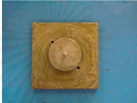
รูปที่ 11 แสดงแทนฐานของเบ้าโลหะสำหรับหล่อกล่องอะคริลิก มีช่องสำหรับส่วนหัวของ ฟันหลักรากเทียมจำลองฝังอยู่บริเวณฐาน
