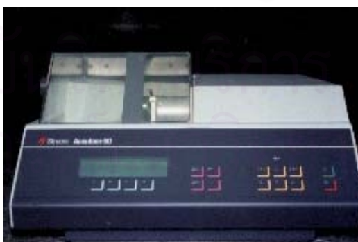
ภาพที่ 7 ภาพเครื่องตัดฟันใบเลื่อยเพชรชนิดความเร็วต่ำ
