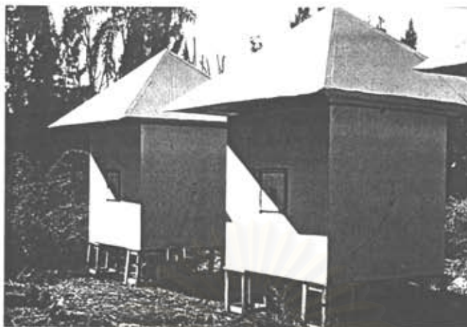
รูปที่ 4-13 แสดงการทดลองชุดที่ 3 ทดสอบฉนวนและการระบายอากาศ
