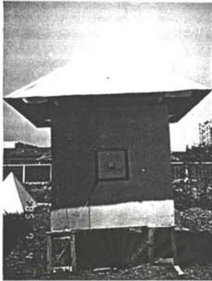
รูปที่ 4-10 แสดงรายละเอียดกล่องทดลองชุดที่ 3 ทดสอบฉนวนและการระบายอากาศ
