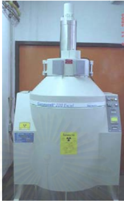
รูปที่ 3.1 เครื่องฉายรังสีแกมมาจาก โคบอลต์-60 รุ่น Gammacell 220 Excel ที่สำนักงานปริมาณ เพื่อสันติ
