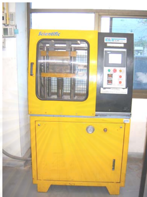
รูปที่ 3.3 เครื่องขึ้นรูปโพลีเมอร์เป็นแผ่น (Compression molding)
