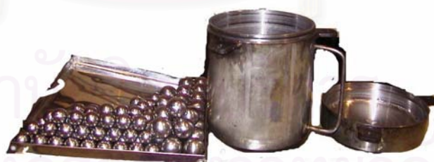
รูปที่ 4.2 ลูกบดและหม้อบดทำจากเหล็กกล้าไร้สนิม
