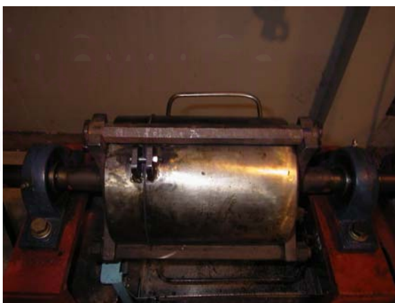
รูปที่ 4.7 การยึดหม้อบดกับแกนหมุน
