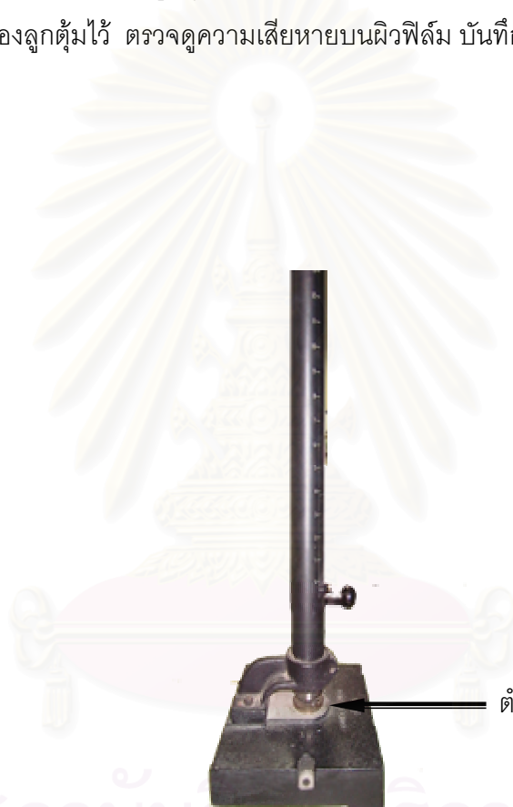
รูปที่ 4.11 อุปกรณ์ทดสอบแรงกระแทก
