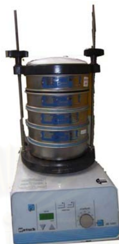
รูปที่ 4. 6 ชุดเครื่องร่อนตะแกรง
