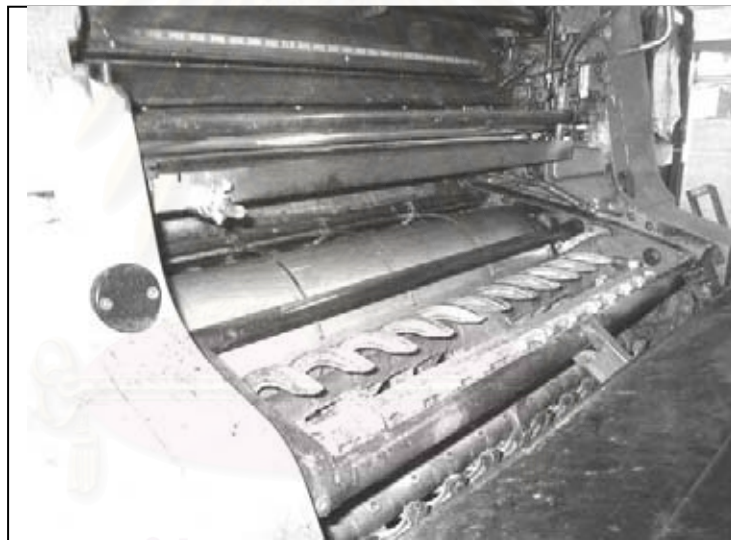
ภาพที่ 3.25 กริปเปอร์ของเครื่องพิมพ์ออฟเซตชนิดป้อนแผ่น
