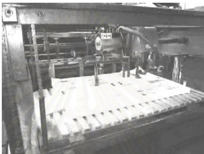
ภาพที่ 4.14 หน่วยป้อนกระดาษของเครื่องพิมพ์ออฟเซต
