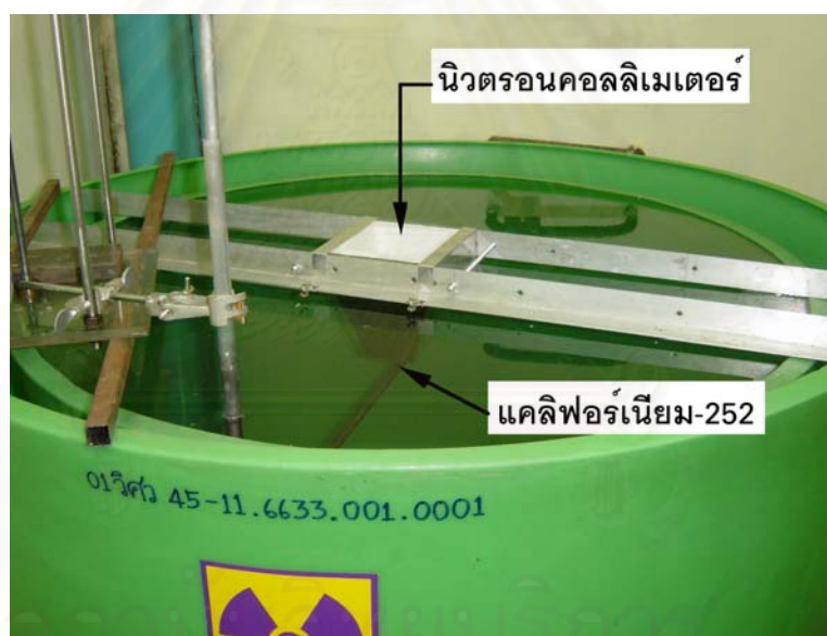
รูปที่ 3.3 ต้นกำเนิดนิวตรอนแคลิฟอร์เนียม-252 และนิวตรอนคออลลิเมเตอร์ที่อยู่ในถังโพลีเอทิลีนบรรจุน้ำ
