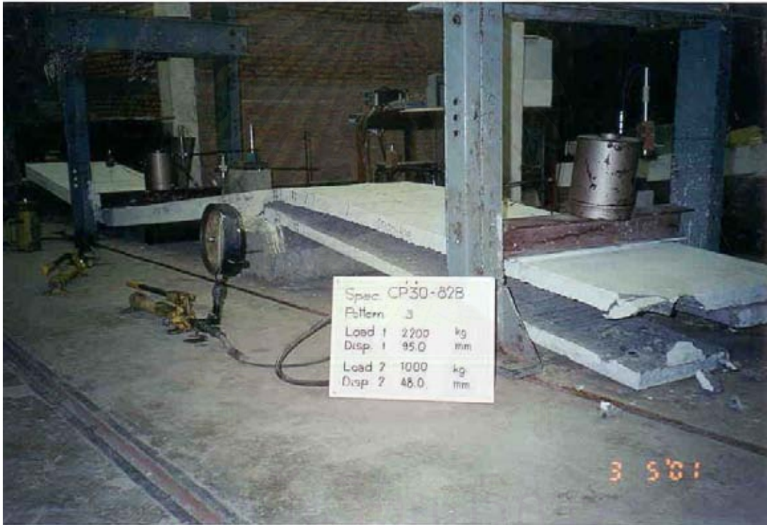
รูปที่ 3.11 การเริ่มแตกแยกจากแรงเค้นของส่วนเททึบหน้า ( ตัวอย่าง CP30-82B )
