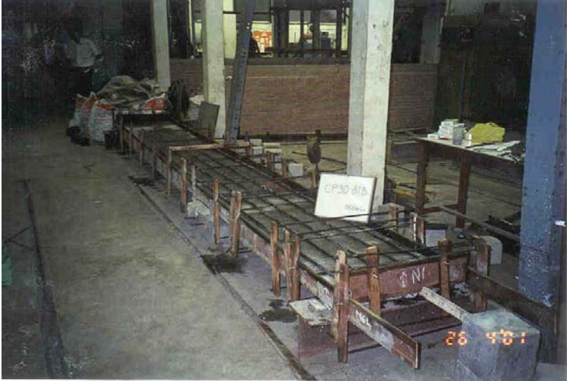
รูปที่ 3.5 การเตรียมตัวอย่างทดสอบก่อนการทดสอบกริตทับหน้า
