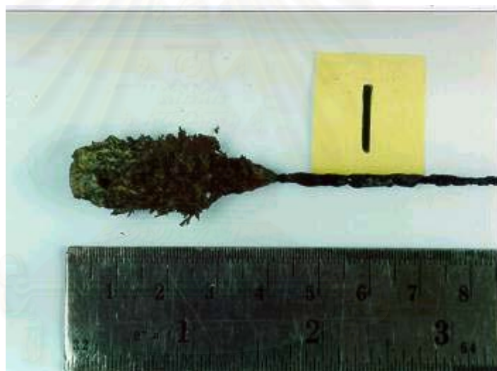
สถาบันวิทยบริการ จุฬาลงกรณ์มหาวิทยาลัย รูปที่ 4.1 แมงกานีสแคโทดที่ได้จากการทดลองเมื่อใช้อิเล็กโทรไลต์ \text{MnCl}_2 - \text{KCl} ที่ \text{MnCl}_2 = 40\% ความหนาแน่นกระแสไฟฟ้า 0.2 \text{ A/cm}^2 อุณหภูมิ 700^\circ\text{C}
