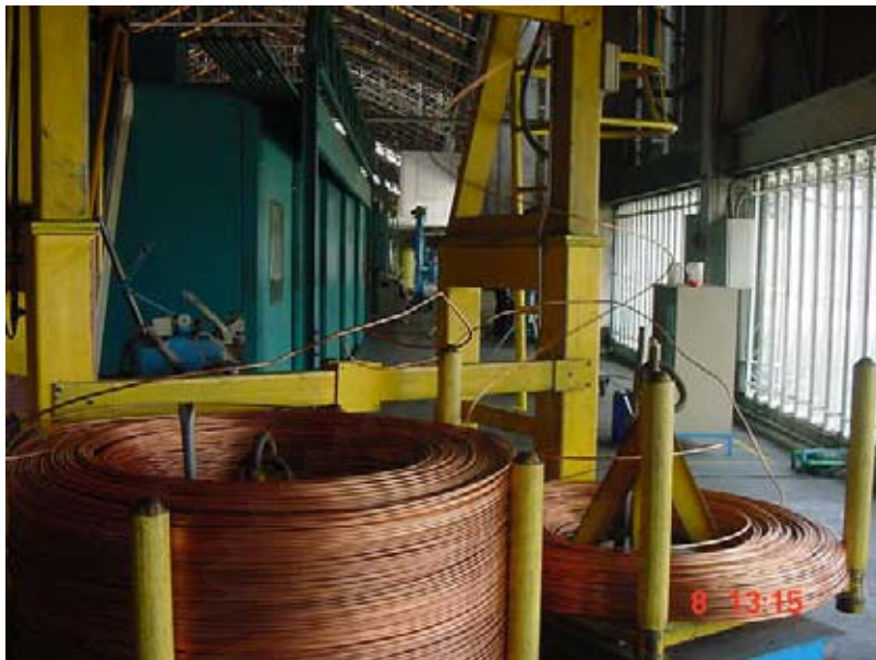
รูปที่ 3.5 แสดงขั้นตอนการป้อน Rod สำหรับเครื่องรีด
