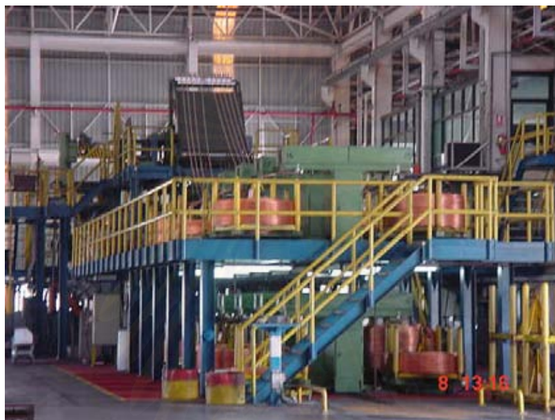
รูปที่ 3.4 แสดง เตาหลอมที่ใช้สำหรับหลอมทองแดง
