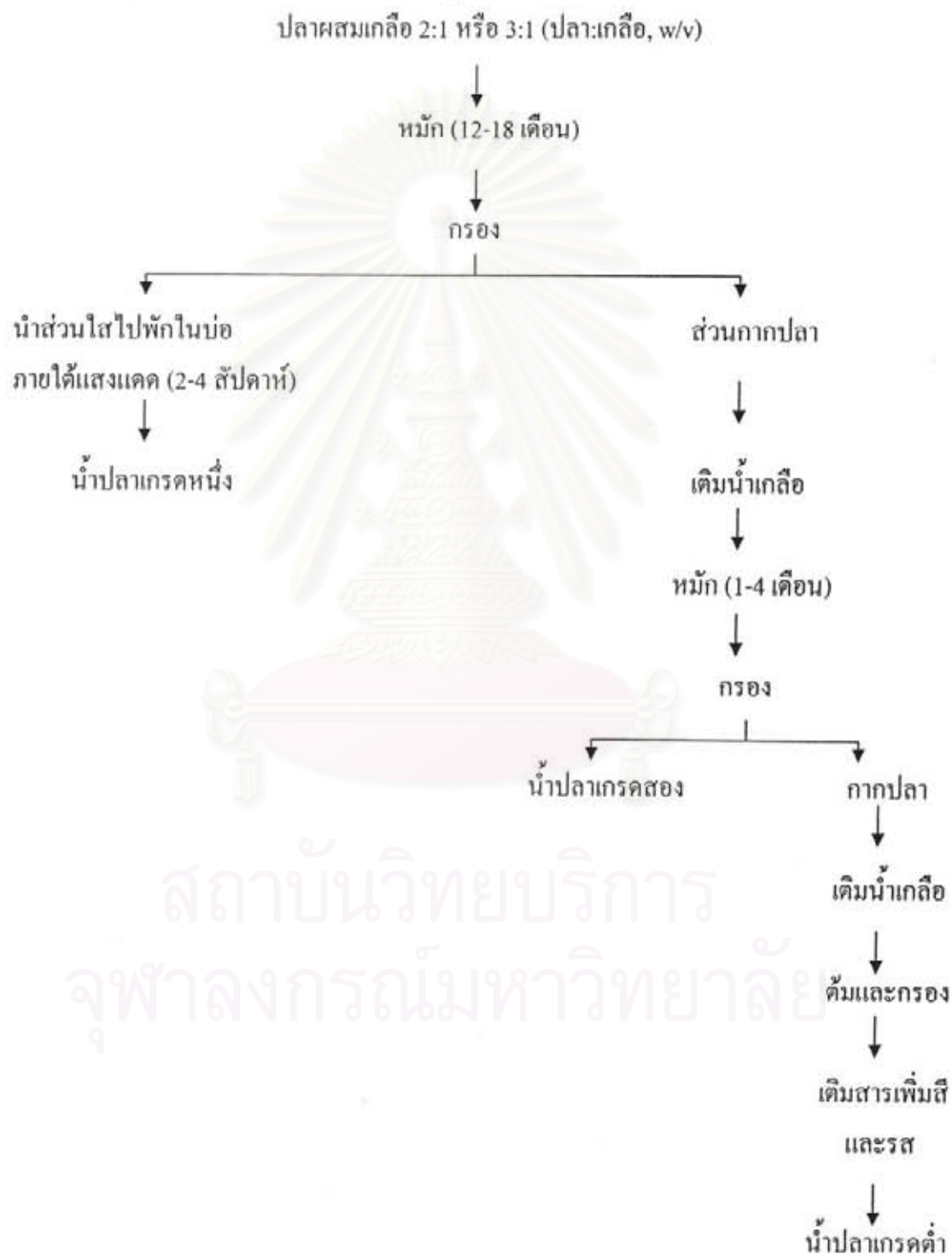
ภาพที่ 2.1 ขั้นตอนการผลิตน้ำปลา
