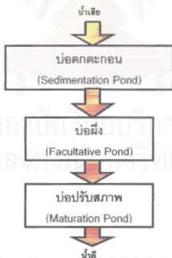
แผนภูมิที่ 5.1 การทำงานของระบบบ่อบำบัดเสถียร (Stabilization Pond, SP)
