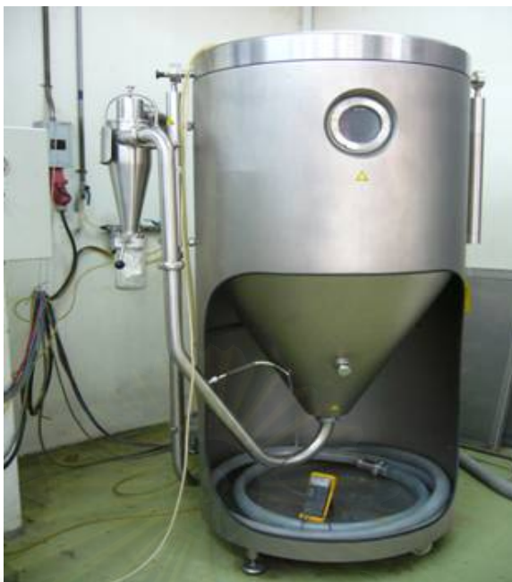
ภาพที่ 3.1 เครื่องอบแห้งแบบพ่นกระจาย (spray dryer) รุ่น DV-II
