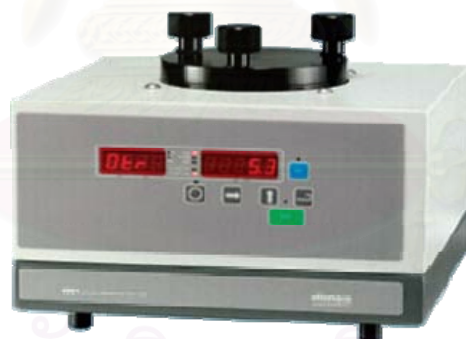
ภาพที่ ข. 4 เครื่องวัดค่าการซึมผ่านของก๊าซออกซิเจน Model 8500
