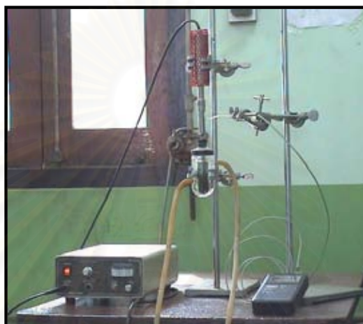
รูปที่ 5.1 ชุดอุปกรณ์ของการสกัดสารอะเซตีลโคโคไซด์ด้วยอัลตราโซนิคโพรบ
