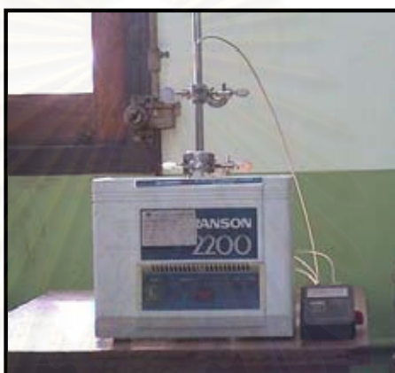
รูปที่ 5.6 ชุดอุปกรณ์ของการสกัดสารอะเซตีลโคโคไซด์ด้วยอ่างทำความสะอาด้วยคลื่นเหนือเสียง
