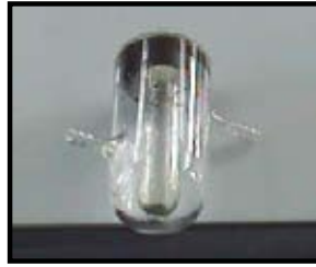
รูปที่ 5.3 คอลัมน์แก้ว 2 ชั้นที่ใช้กับอัลตราโซนิกโพรบ
