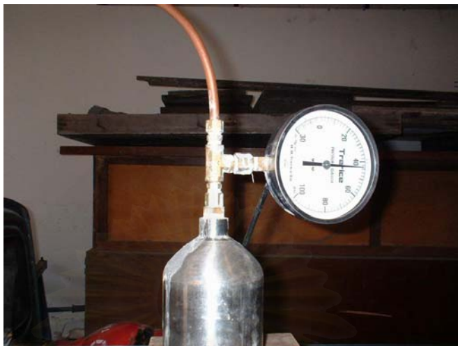
รูปที่ 5.23 แสดงลักษณะถังและมาตรวัดความดันที่ติดเพิ่มเติม
