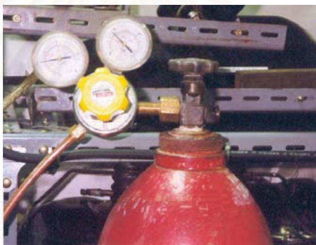
รูปที่ 4.12 แสดงอุปกรณ์ปรับความดันก๊าซไฮโดรเจน
