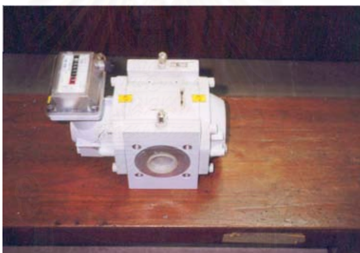
รูปที่ 4.2 แสดงมาตรวัดปริมาตรไฮโดรเจนมาตรฐานที่ใช้ในการทดสอบ
