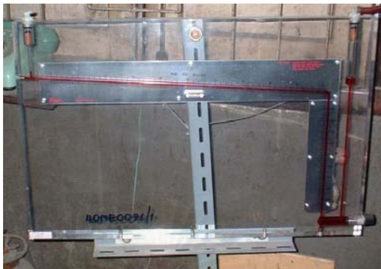
รูปที่ 4.5 แสดง incline manometer ที่ใช้ในการวัดความดันตกคร่อม orifice
