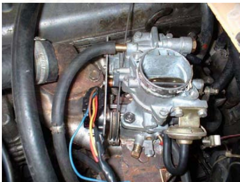
รูปที่ 5.4 แสดงการติดตั้งอุปกรณ์วัดตำแหน่งปีกผีเสื้อ
