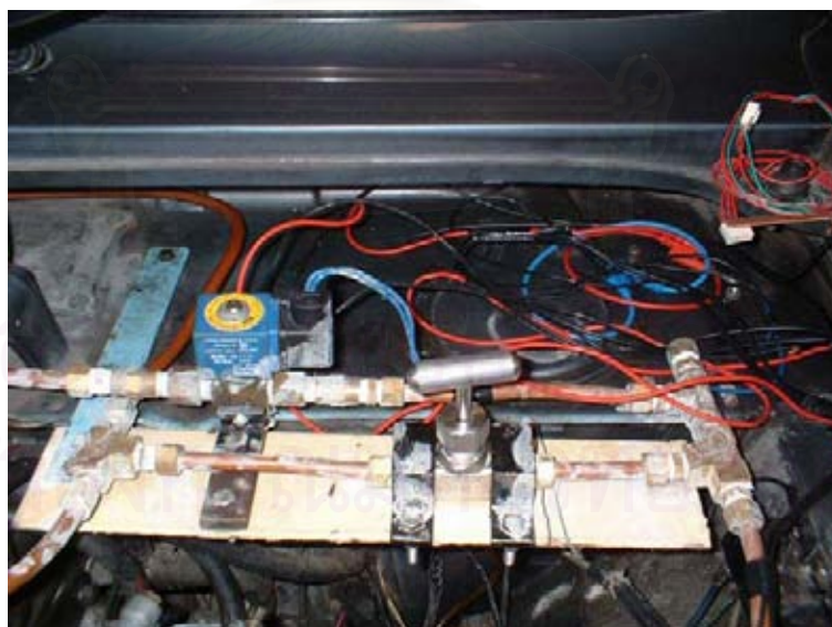
รูปที่ 5.22 แสดงการติดตั้งชุดอุปกรณ์ควบคุมปริมาณเชื้อเพลิงแบบอิเล็กทรอนิกส์เข้ากับรถยนต์
