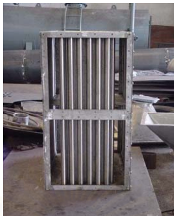
รูปที่ 6.1 ท่อแลกเปลี่ยนความร้อนภายในอุปกรณ์อุณหอากาศ
