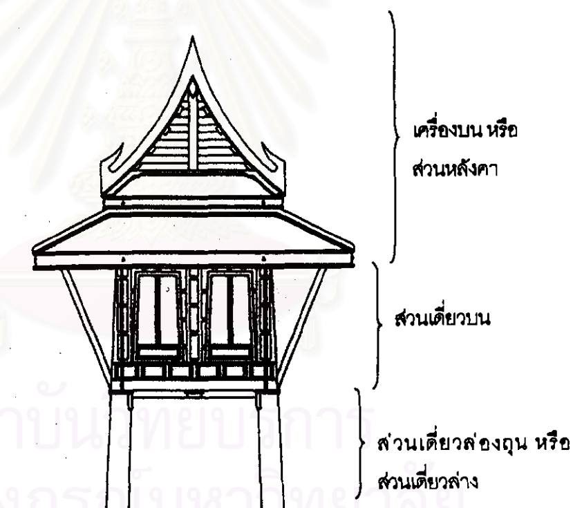
ภาพที่ 2.8 โครงสร้างของเรือนไทยเดิมภาคกลาง
