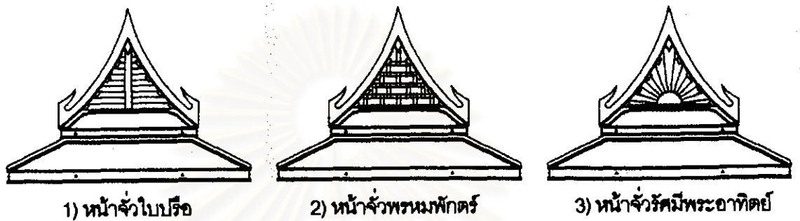
ภาพที่ 2.6 ลักษณะหน้าจั่วของเรือนไทยเดิมภาคกลาง
