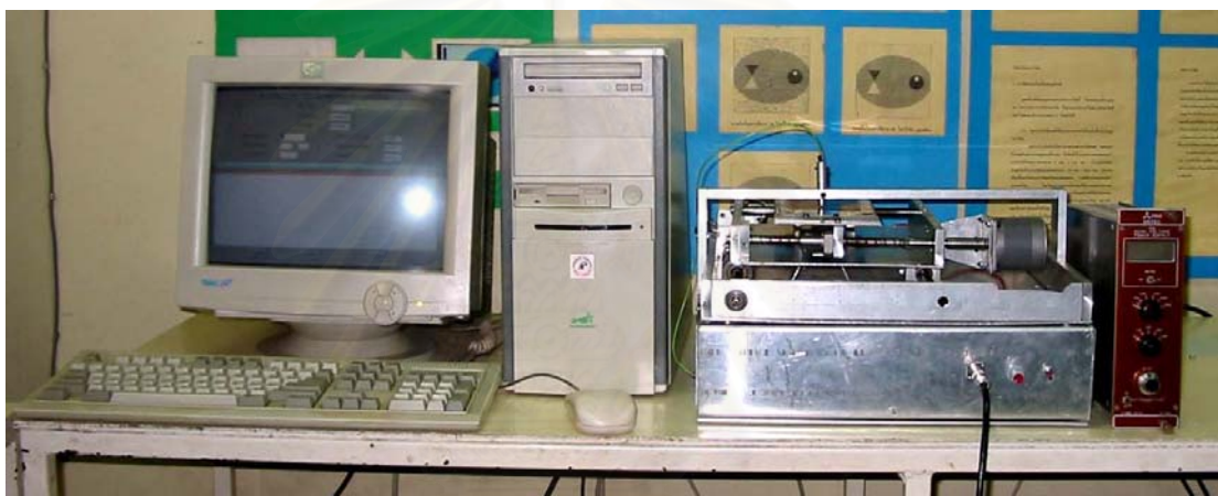
รูปที่ 3.2 ระบบสแกนอ่านค่าความดำอ่านความดำรายละเอียดสูงที่พัฒนาขึ้น
