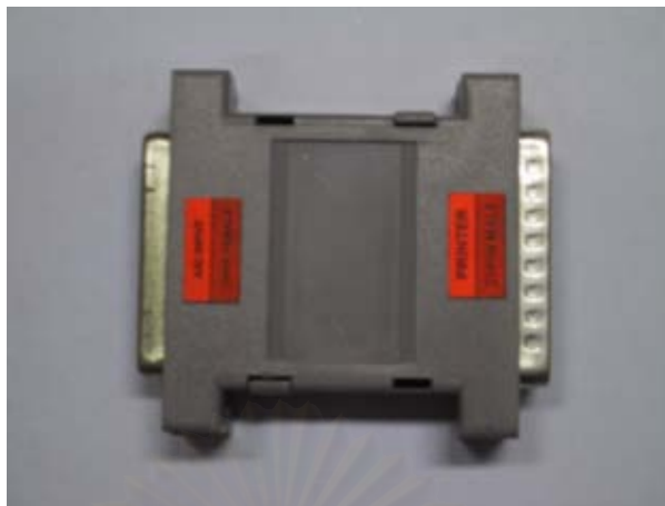
รูปที่ 3.6 อุปกรณ์แปลงสัญญาณอะนาลอกเป็นสัญญาณเชิงตัวเลขขนาด 12 บิต
