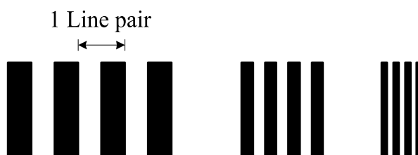
รูปที่ 4.3 ลักษณะฟิล์มที่มีเส้นคู่ (Line pair) สำหรับวิธี MTF
