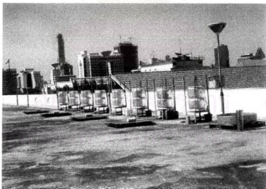
ภาพที่ 3.2 ลานตากจำลองใช้ในการทดลองจำนวน 8 ถัง มีลักษณะเหมือนกัน
