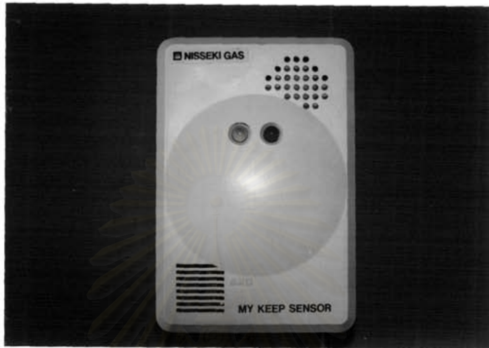
รูปที่ 5.6 ลักษณะภายนอกของตัวตรวจสอบแก๊สรั่ว
