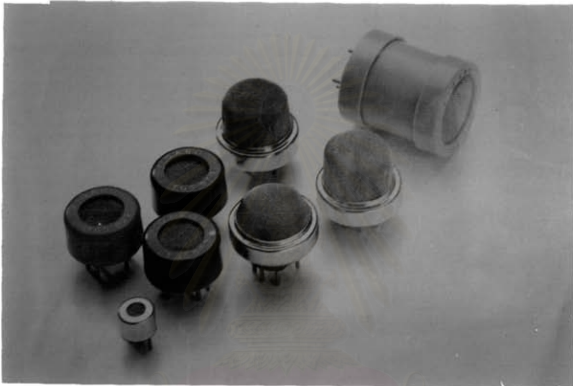
รูปที่ 5.10 หัวตรวจวัดแก๊สที่ใช้ในเชิงพาณิชย์
