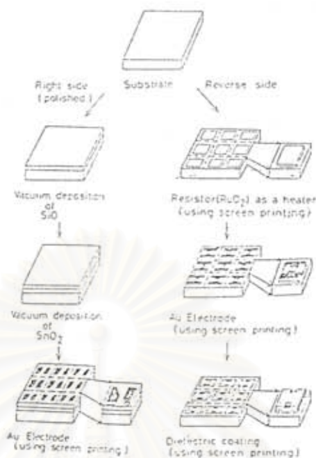
รูปที่ 3.4 กระบวนการเตรียมฟิล์มบาง
