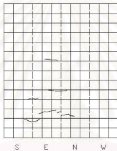
รูปที่ ค1.2 ลักษณะรอยแตกร้าวที่อัตราส่วนการเคลื่อนตัวด้านข้างของเสา 0.5%
