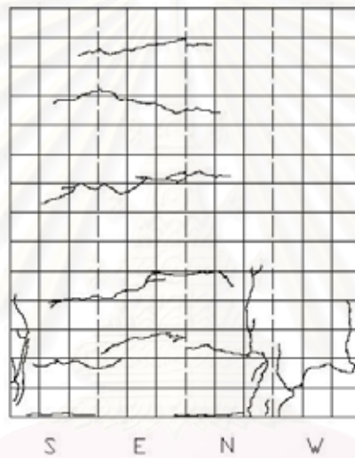
รูปที่ ค1.26 ลักษณะรอยแตกร้าวที่อัตราส่วนการเคลื่อนตัวด้านข้างของเสา 6.2%
