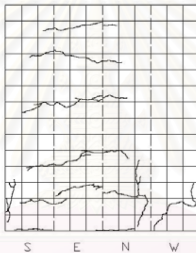
รูปที่ ค1.20 ลักษณะรอยแตกร้าวที่อัตราส่วนการเคลื่อนตัวด้านข้างของเสา 4.6%
