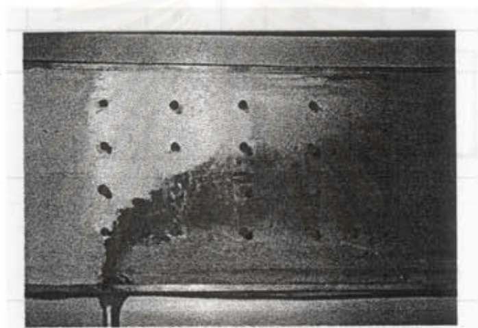
รูปที่ 5.3b การกระจายตัวของน้ำร้อนที่อัตราการไหล 0.028 ลิตร/วินาที
