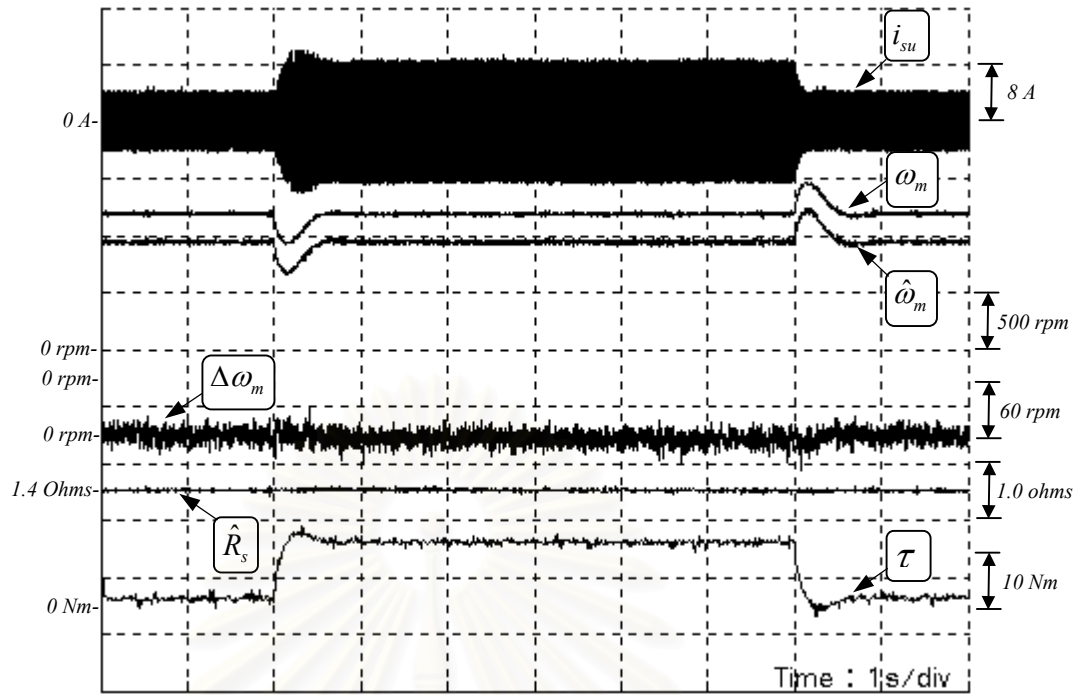
รูปที่ 4.56 ผลตอบสนองของสภาวะชั่วครู่ขณะใส่โหลดพิกัดเมื่อมอเตอร์ทำงานที่ความเร็ว 1200 rpm เมื่อใช้รีเกรสเซอร์เวกเตอร์ Qi_s
