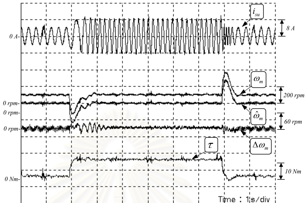
รูปที่ 3.14 ผลตอบสนองของสถานะชั่วครู่ขณะใส่โหลดพิกัดเมื่อมอเตอร์ทำงานที่ความเร็ว 100 rpm ( \Delta R_s = 0 )
