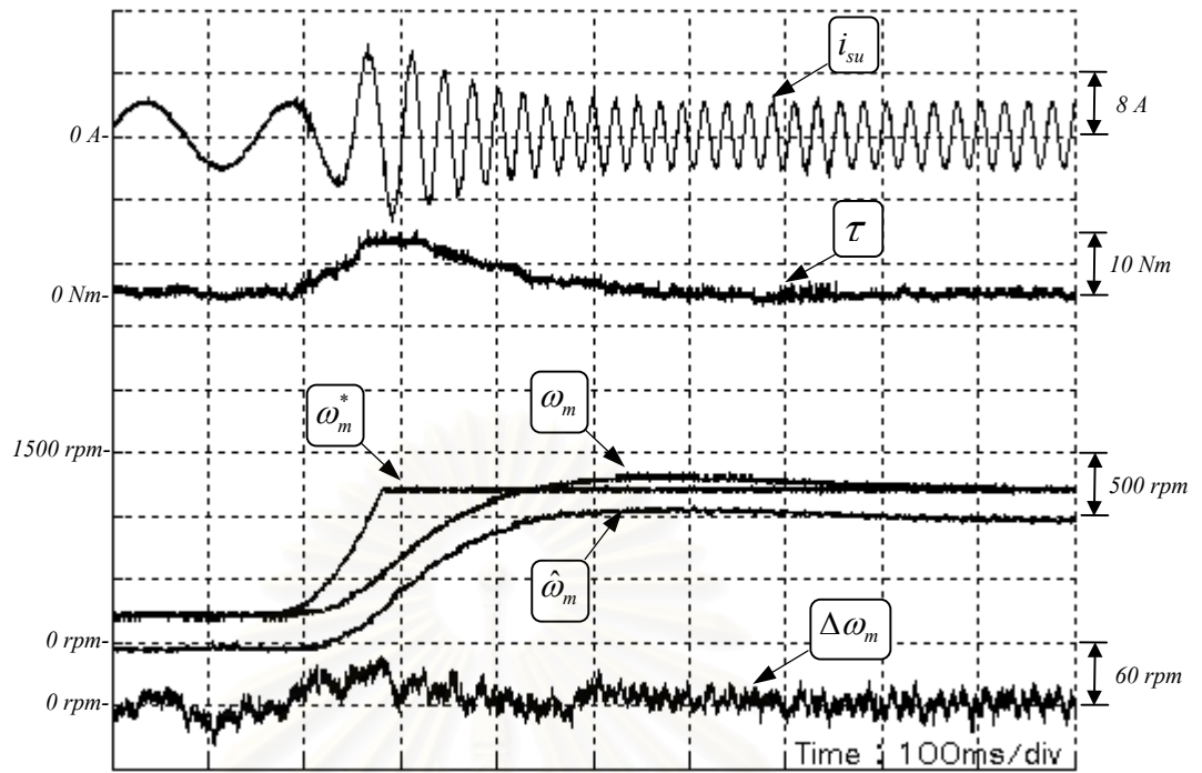
รูปที่ 3.10 ผลตอบสนองของสภาวะชั่วคราวขณะเร่งความเร็วของมอเตอร์จาก 200 ไป 1200 rpm ( \Delta R_s = 0 )
