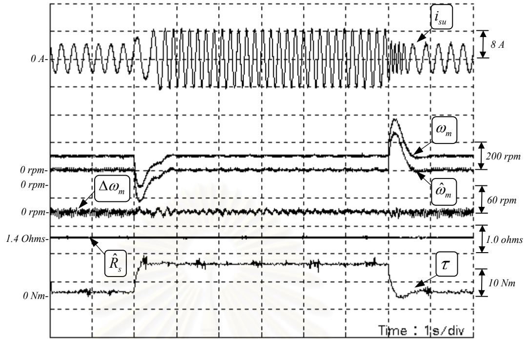
รูปที่ 4.38 ผลตอบสนองของสภาวะชั่วครู่ขณะใส่โพลดพิกัดเมื่อมอเตอร์ทำงานที่ความเร็ว 100 rpm เมื่อใช้รีเกรสเซอร์เวกเตอร์ -J \text{sgn}(\hat{\omega}_{mR}) i_s
