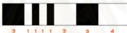
รูปที่ 2.8 ตัวอย่างของคำรหัสในรหัสแท่ง 2 มิติ PDF417
