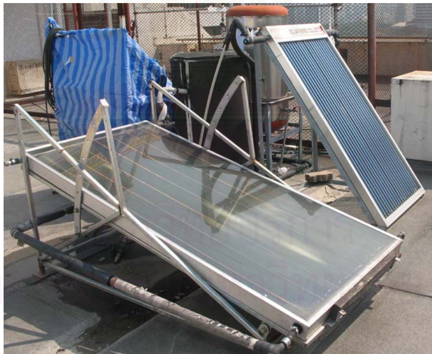
รูปที่ 4.11 แผงรับแสงอาทิตย์แบบแผ่นเรียบและแบบฮีตไปป์ที่ใช้ในการทดลอง
