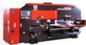
รูปที่ 3.10 รูปเครื่องเจาะ CNC รุ่น VIPROS 20 Tons Series
