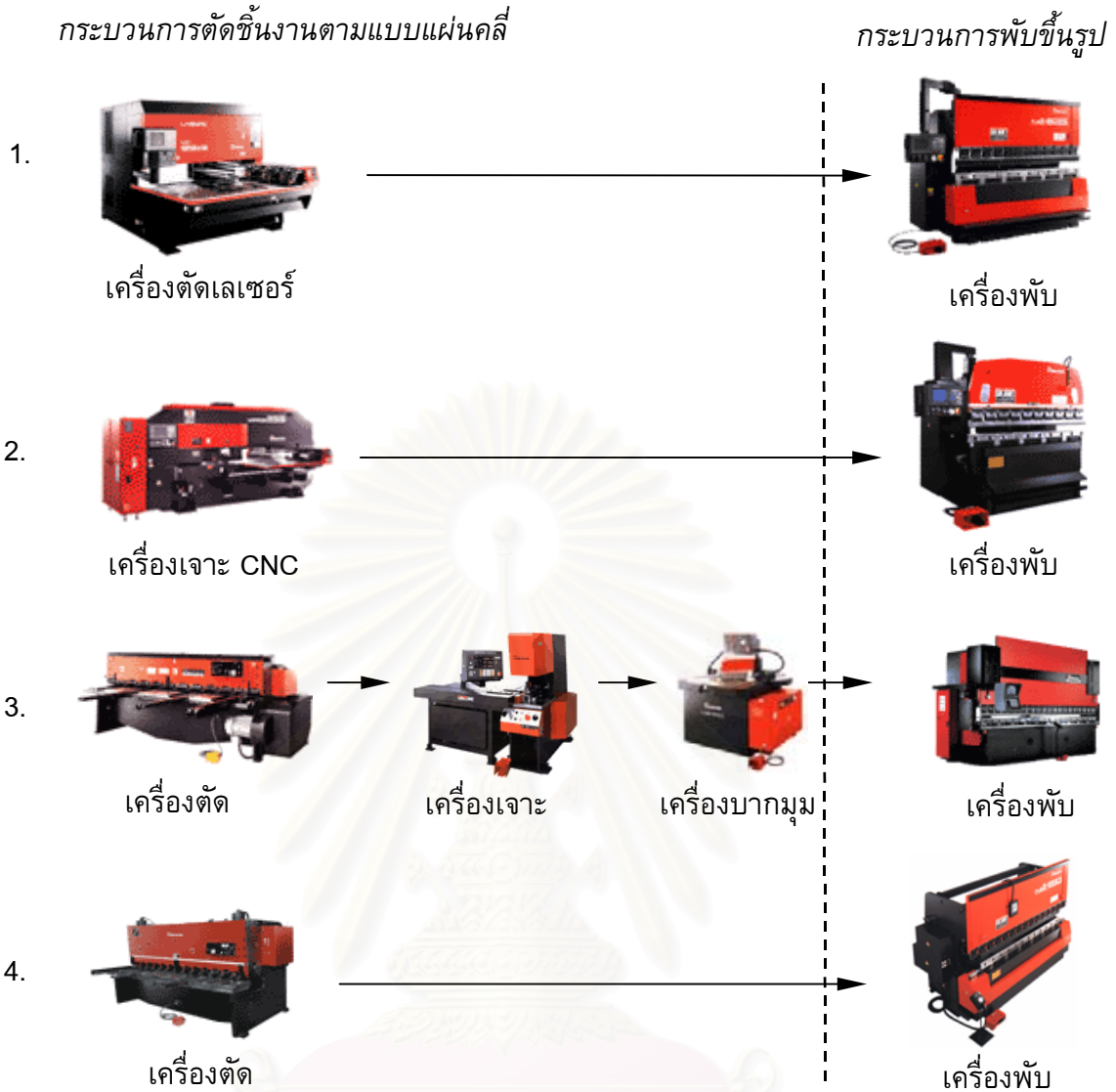
รูปที่ 3.1 ทางเลือกต่าง ๆ ของกระบวนการทำงานแปรรูปโลหะแผ่น
