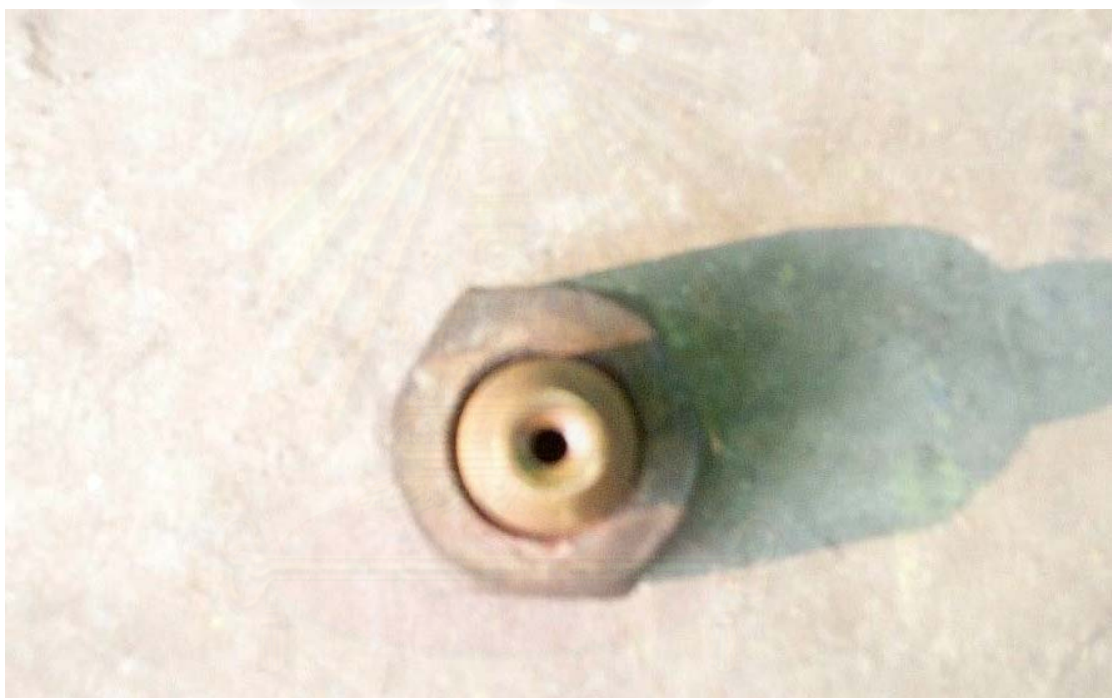
สถาบันวิทยบริการ รูปที่ 3.16 แสดงหัวฉีด (Spray Nozzle) ของน้ำหล่อเหล็กแท่งช่วงที่ 2 จุฬาลงกรณ์มหาวิทยาลัย
