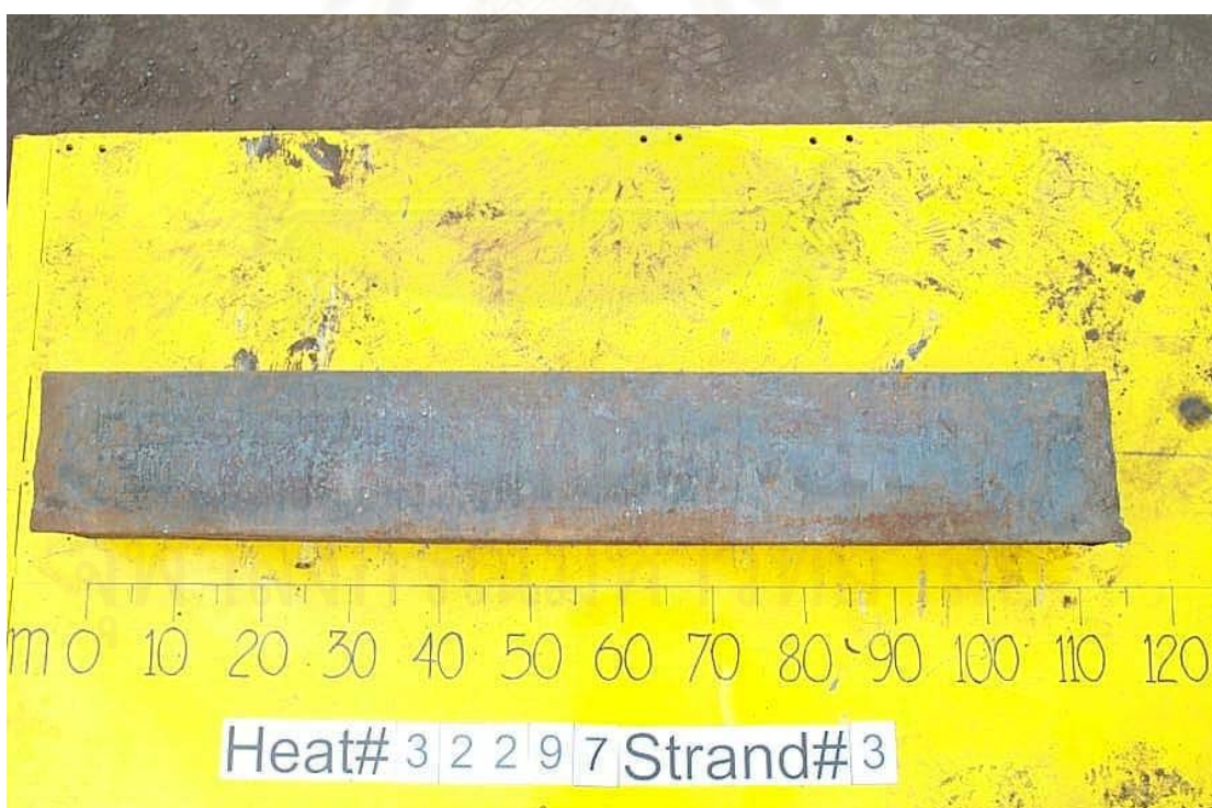
รูปที่ 30 แสดงเหล็กปลายสั้นในส่วนของการทดลองเพื่อหาสภาวะที่เหมาะสม ลำดับการทดลองที่ 30
