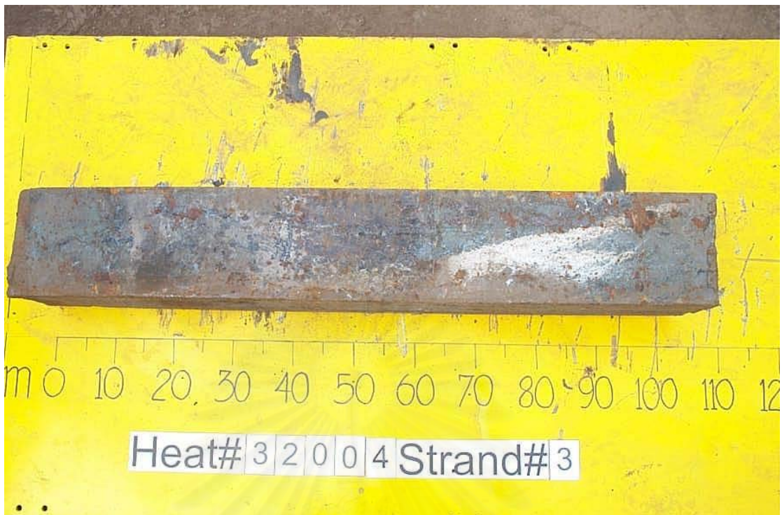
รูปที่ 25 แสดงเหล็กปลายสั้นในส่วนของการทดลองเพื่อหาสภาวะที่เหมาะสม ลำดับการทดลองที่ 25
