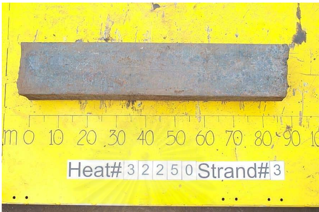
รูปที่ 29 แสดงเหล็กปลายสั้นในส่วนของการทดลองเพื่อหาสภาวะที่เหมาะสม ลำดับการทดลองที่ 29
