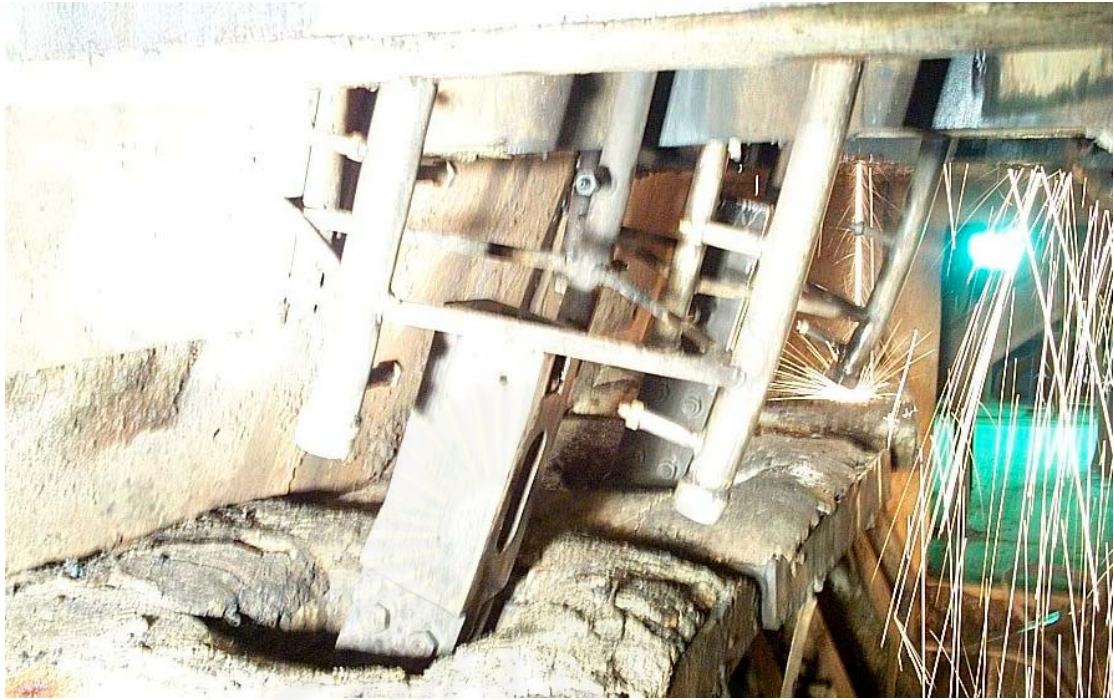
รูปที่ 3.5 แสดงเหล็กหล่อตัวนำเหล็กแท่ง (Dummy Bar)
