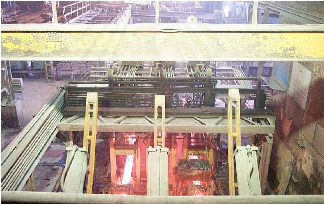
จุฬาลงกรณ์มหาวิทยาลัย รูปที่ 3.23 แสดงสายผลิตในการหล่อ (Casting Strand)
