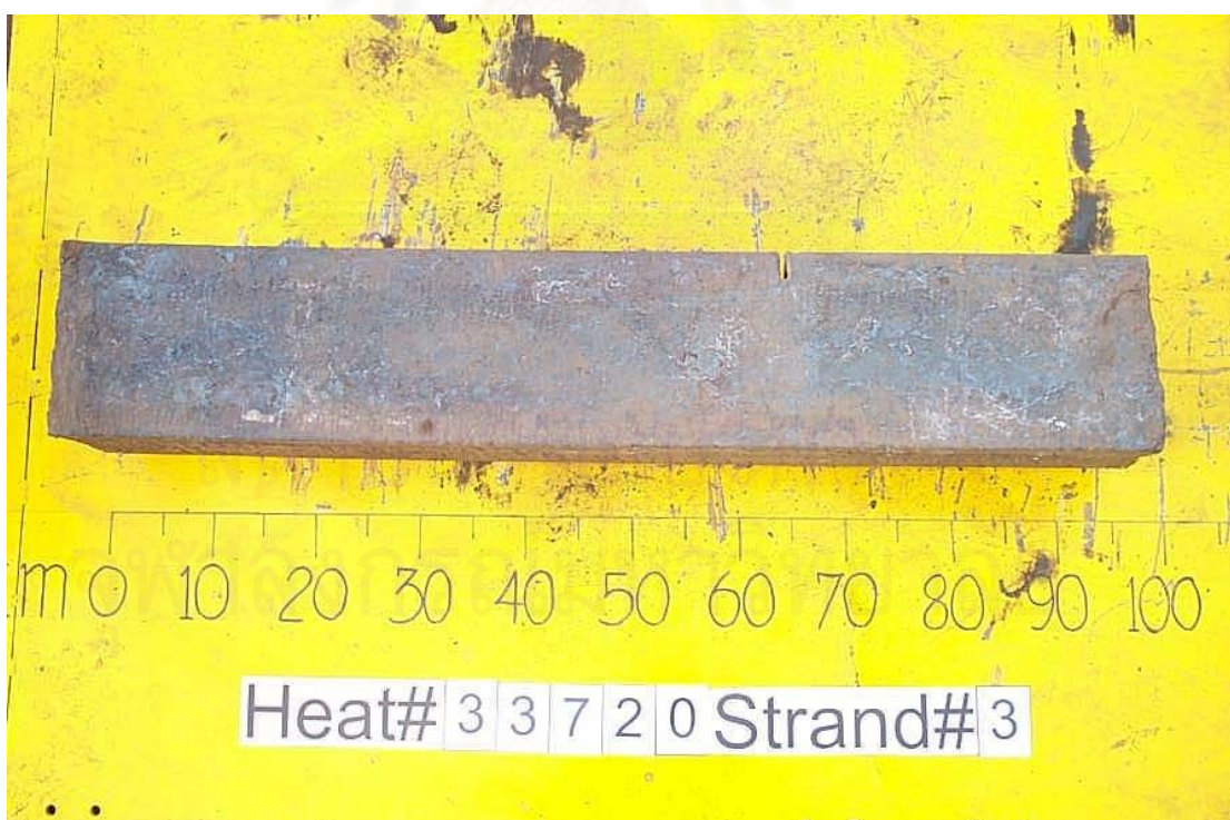
รูปที่ 50 แสดงเหล็กปลายสั้นในส่วนของการทดลองเพื่อหาสภาวะที่เหมาะสม ลำดับการทดลองที่ 50
