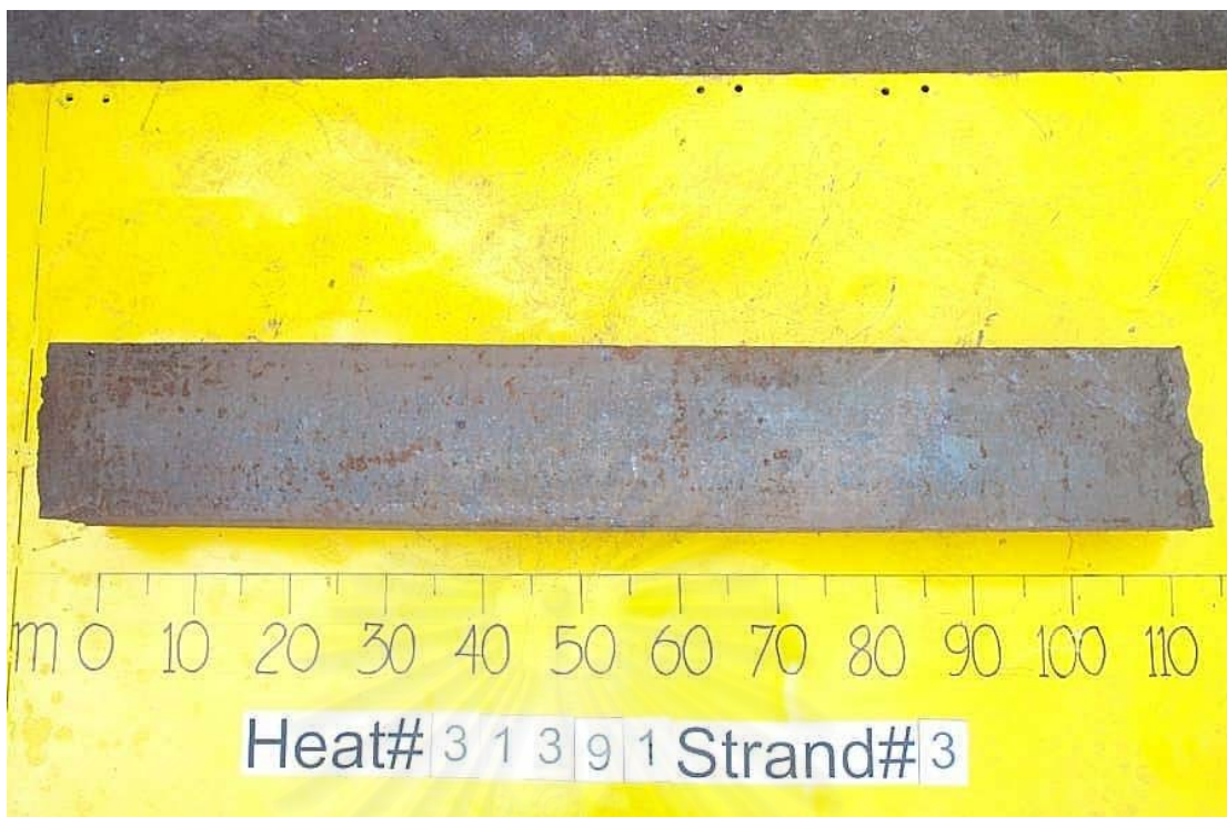
รูปที่ 7 แสดงเหล็กปลายสั้นในส่วนของ การทดลองเพื่อหาสภาวะที่เหมาะสม ลำดับการทดลองที่ 7
