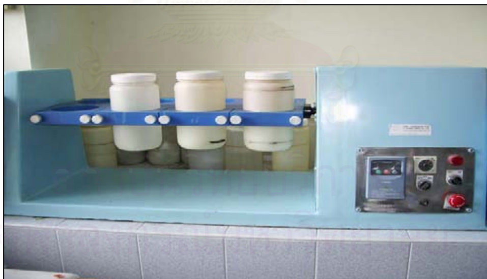
รูปที่ 3.2 เครื่องเขย่าแบบหมุนตามมาตรฐานประกาศกระทรวงอุตสาหกรรมฉบับที่ 6 (พ.ศ. 2540)
