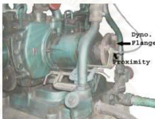
รูปที่ 4-5 แสดงจุดติดตั้งอุปกรณ์วัดความเร็วรอบของเครื่องยนต์
