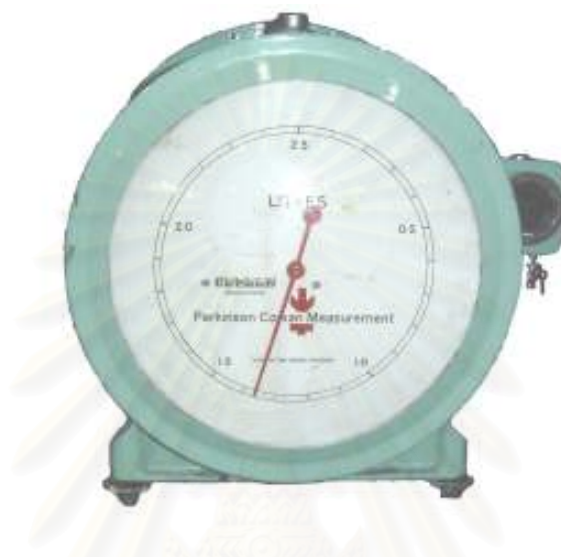
รูปที่ 4-8 แสดงภาพ Liquid Seal Drum Gas Meter ที่ใช้ในการวัดอัตราการไหลของก๊าซหุงต้ม
