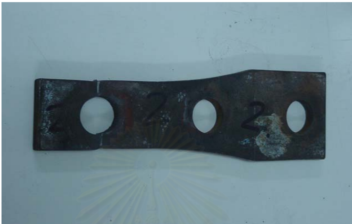
รูปที่ 4-9 แสดงลักษณะการวิบัติของชิ้นงานทดสอบความล้า
