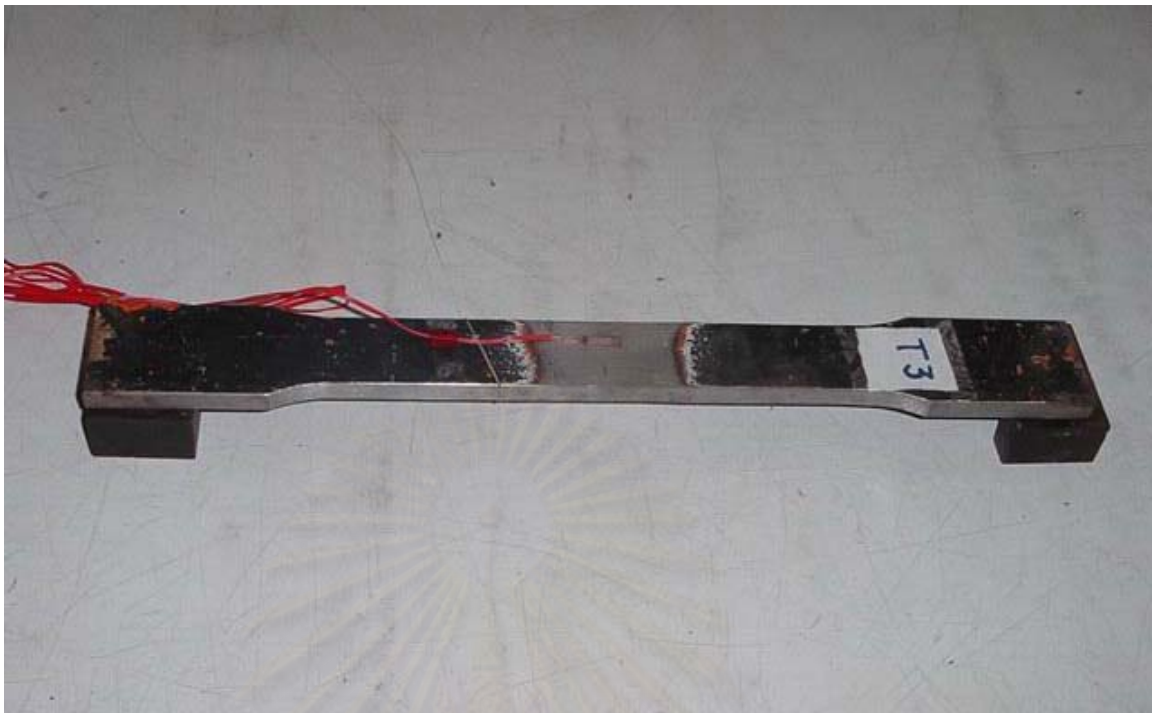
รูปที่ 4-3 แสดงลักษณะชิ้นงานรับแรงดึงก่อนการทดสอบ
