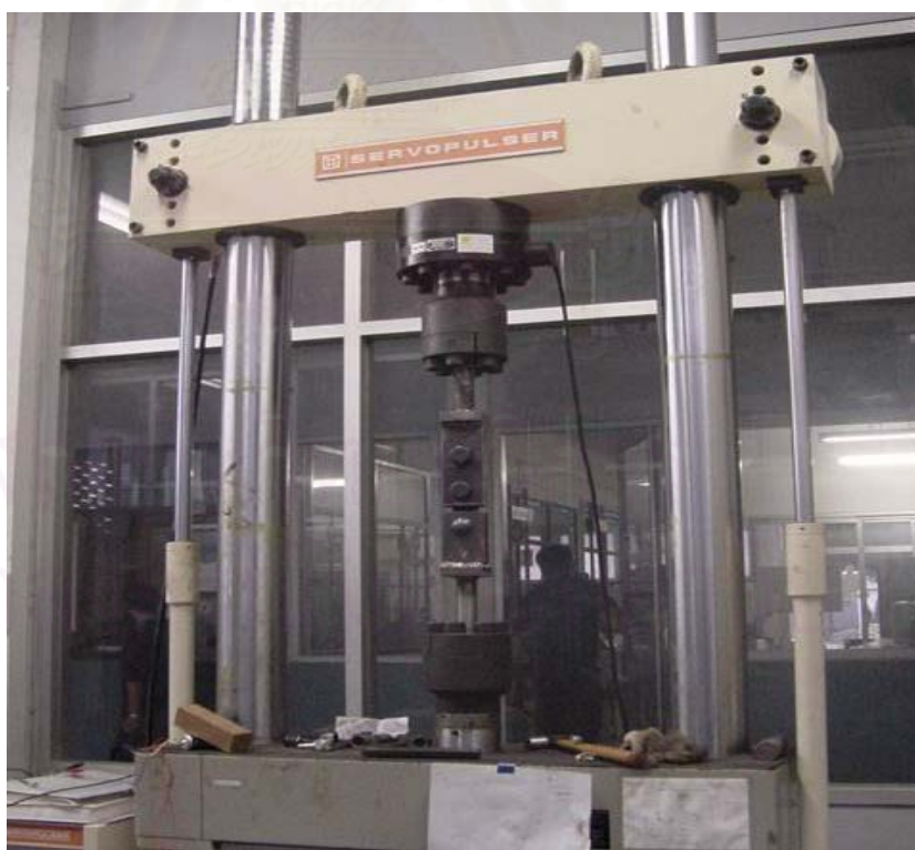
รูปที่ 4-8 แสดงรูประหว่างการทดสอบความล้า
