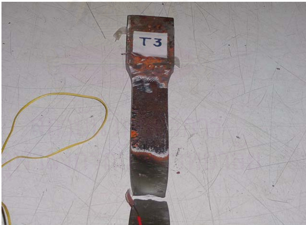
รูปที่ 4-6 แสดงการวิบัติของชิ้นส่วนรับแรงดึง กม.03 T3
