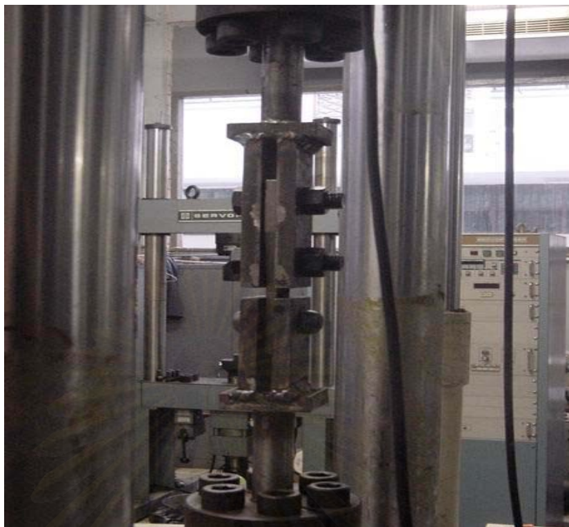
รูปที่ 4-7 แสดงการติดตั้งชิ้นงานทดสอบความล้า
