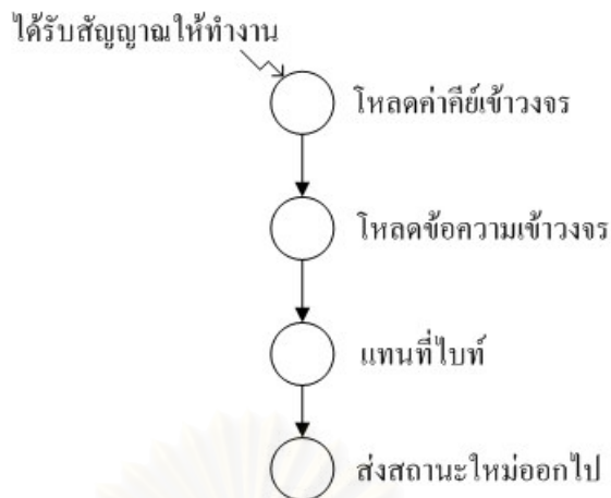
รูปที่ 5.6 แผนภาพสถานะการทำงานคร่าวๆของวงจรไซเฟอร์ 0 และ 1
