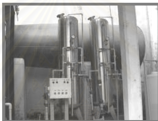
รูปที่ 4.11 ชุดทดลองการเดินระบบต่อเนื่องในระบบขนาดต้นแบบ
