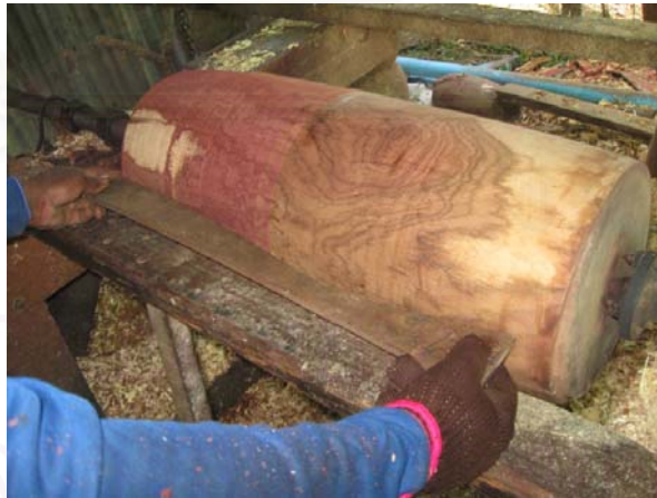
ภาพที่ 104 การนำไม้กระสวนวัดเป็นแบบ
