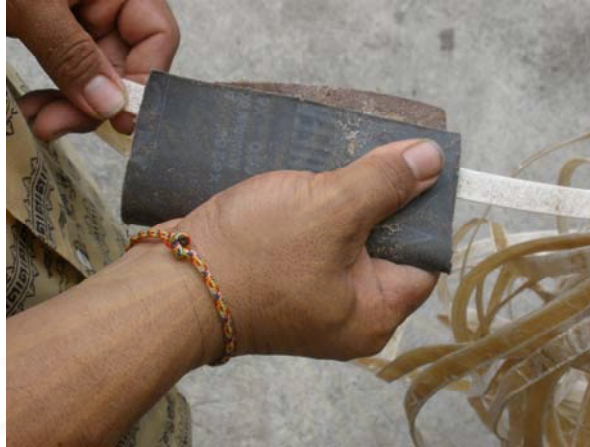
ภาพที่ 162 การขัดหนังเรียคด้วยกระดาศทราย
