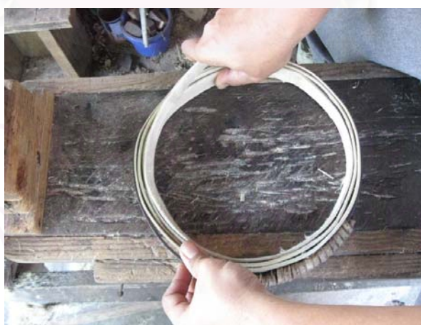
ภาพที่ 146 ขดไม้ไผ่ซ้อนกันสี่ชั้น
