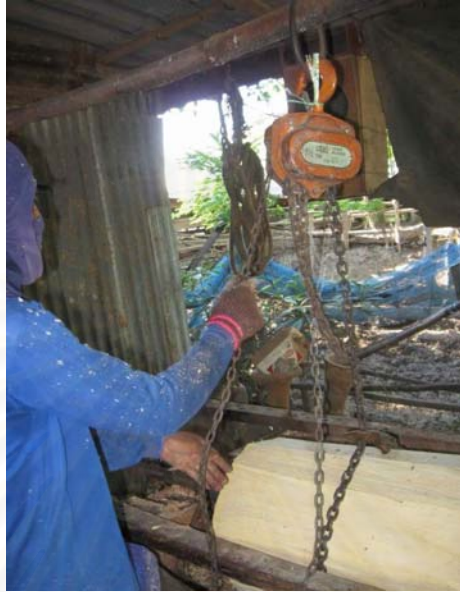
ภาพที่ 97 การนำท่อนไม้ขึ้นแทนกลึง
