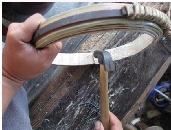
ภาพที่ 148 การตอกตะปูด้านในขอบ
