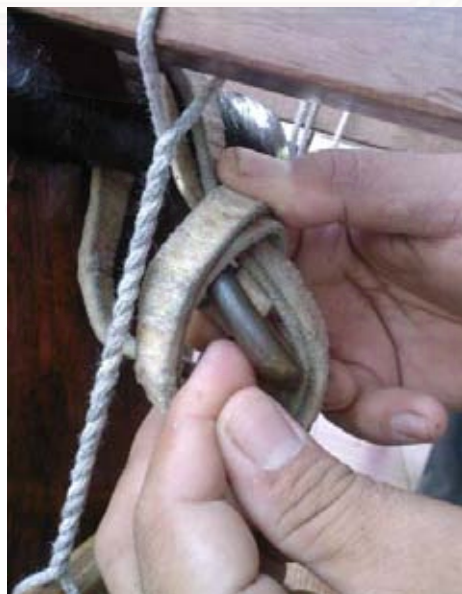
ภาพที่ 174 การผูกปมหรือหูช่อง
