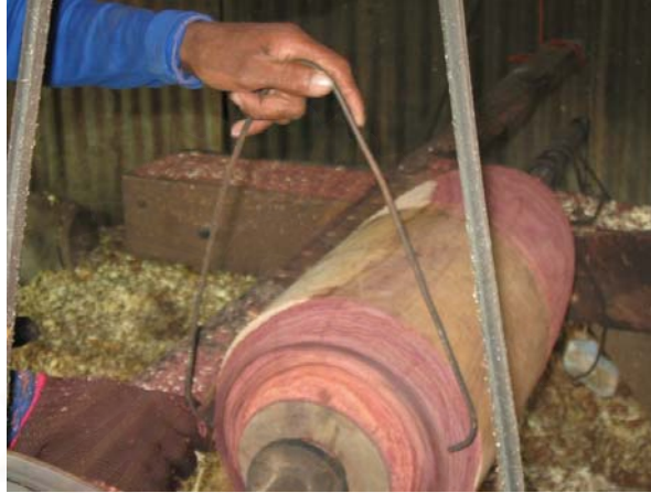
ภาพที่ 105 การใช้เหล็กวัดขนาดขอบปากกลอง
