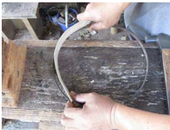
ภาพที่ 145 การขดไม้ไผ่เข้าขอบ
