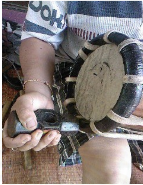
ภาพที่ 177 การใช้หัวค้อนปอนด์ปรับหน้ากลอง
