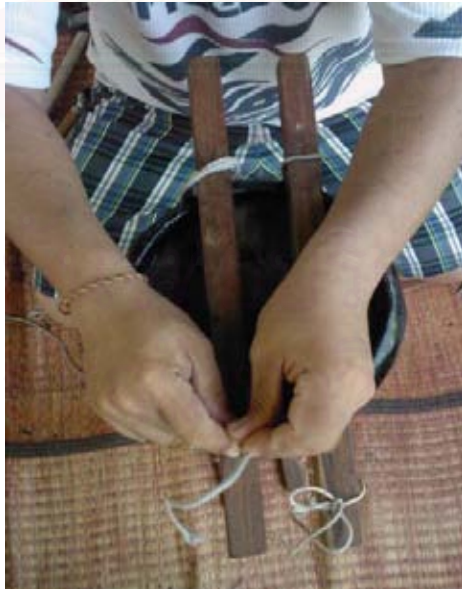
ภาพที่ 168 การร้อยเชือกเพื่อชันชะเนาะ
