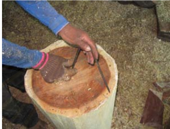
ภาพที่ 95 การใช้วงเวียนวัดหาศูนย์กลาง
