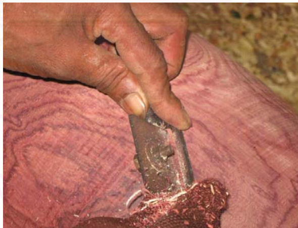
ภาพที่ 108 ใช้กบมือชุดผิวหุ่นให้เรียบ
