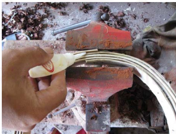
ภาพที่ 150 การหยอดกาวให้ขอบสนิทแน่น
