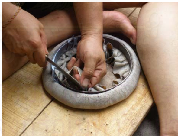
ภาพที่ 157 การใช้มีดตัดชายหนังออก
