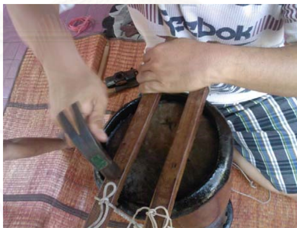
ภาพที่ 170 การใช้ค้อนตอกหน้ากลองให้ตั้งตรง
