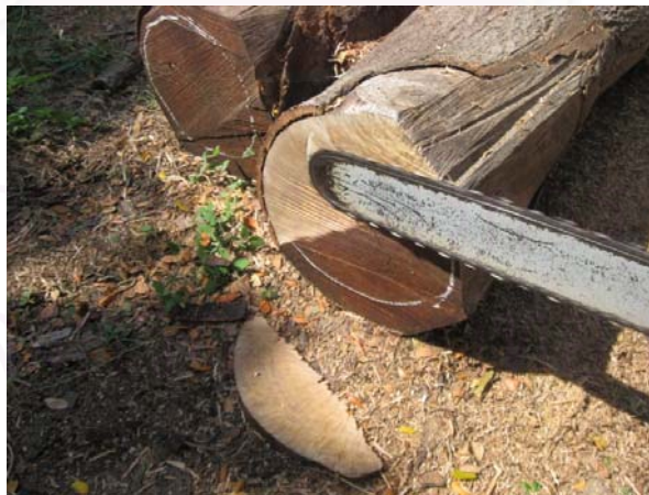
ภาพที่ 94 การตัดท่อนไม้ด้วยเลื่อยยนต์ให้ได้ขนาด ก่อนนำขึ้นแท่นกลึง
