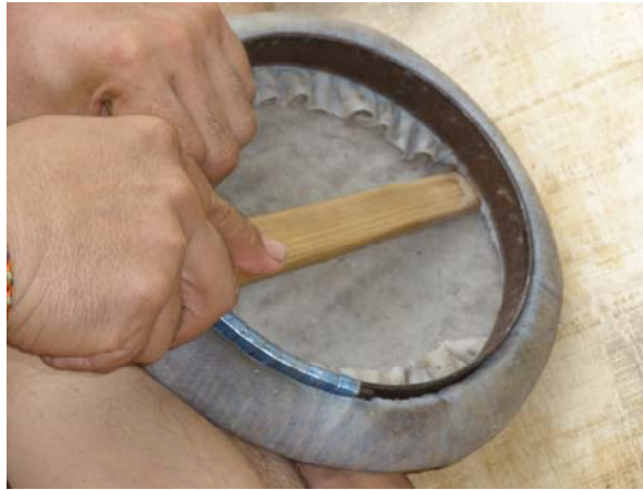
ภาพที่ 158 การขัดชายหนังเข้าขอบด้วยไม้ปากเปิด
