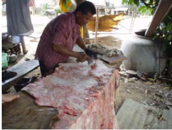
ภาพที่ 131 การนำหนังที่ล้างแล้วมาขูดคราบไขมันออกทิ้ง
