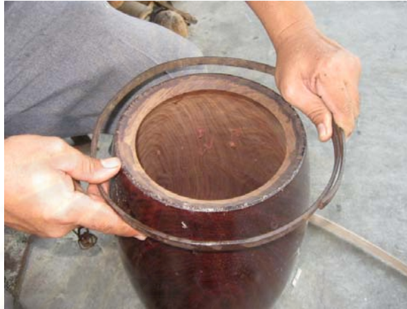
ภาพที่ 143 การนำเหล็กมัดกับปากกลอง
