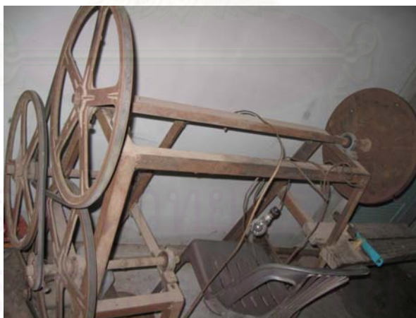
ภาพที่ 63 เฟืองทดรอบและสายพานส่วนประกอบของเครื่องชักเรียด
