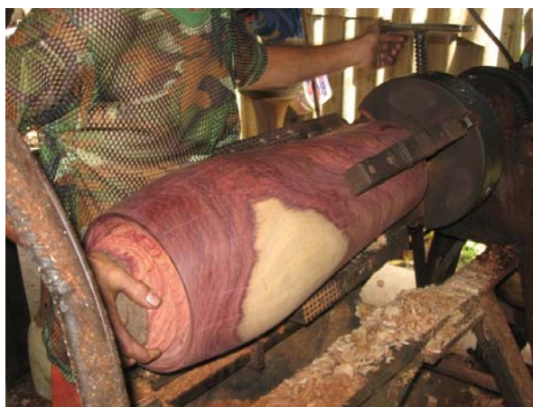
ภาพที่ 112 การจับหุ่นกลองกับหัวจับสามขา
