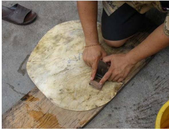
ภาพที่ 136 การใช้กบไสแต่งหนังที่ตากแล้ว
