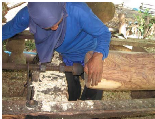
ภาพที่ 98 การนำไม้ฮีดกับแทนหัวจับ
