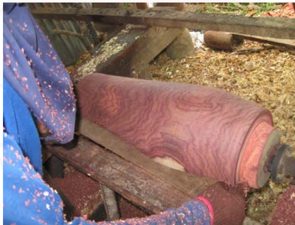
ภาพที่ 106 การวัดขนาดกับไม้กระสวนอีกครั้ง
