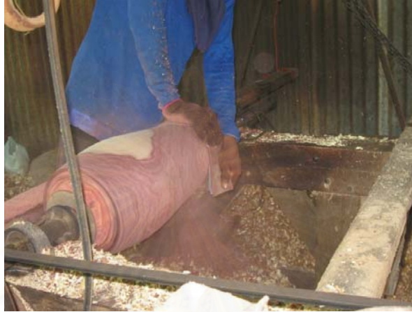
ภาพที่ 109 การขัดมันด้วยกระดาดทราย
