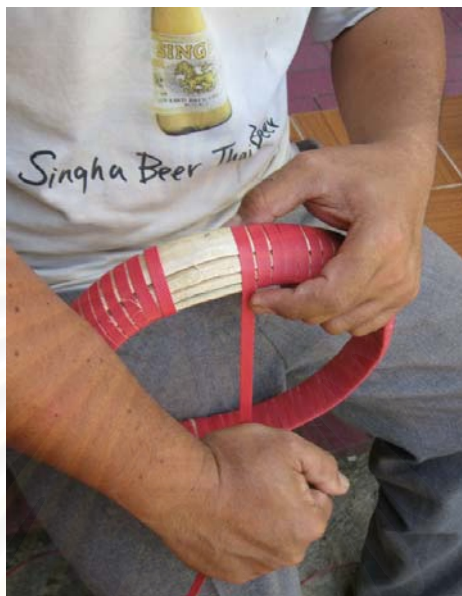
ภาพที่ 153 การพันหุ้มขอบด้วยเส้นพลาสติก
