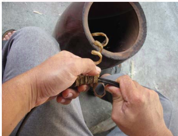
ภาพที่ 144 การพันเส้นหนังยึดกับเหล็ก
