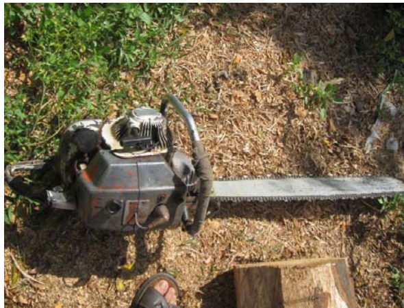
ภาพที่ 93 เลื่อยยนต์อุปกรณ์ที่ใช้แต่งไม้ก่อนกลึงหุ่นกลอง
