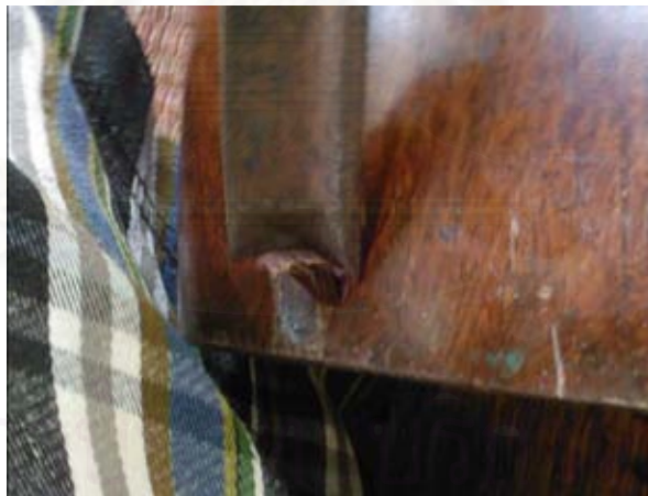
ภาพที่ 164 การใช้สิ่วเล็บมือบากช่องไม้ปากหุ่นกลอง
