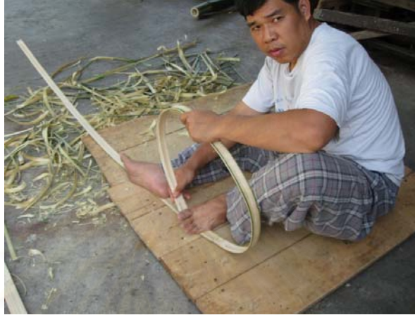
ภาพที่ 128 การขดไม้ไผ่เป็นวง
