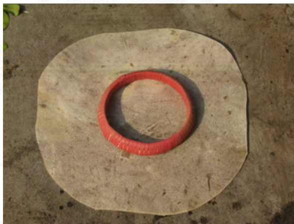
ภาพที่ 155 การนำขอบไม้ไผ่มาวางบนหนังที่แช่น้ำแล้ว
