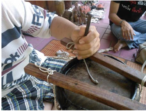
ภาพที่ 171 การตอกเหล็กเพื่อร้อยหนังเรียด
