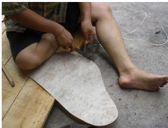
ภาพที่ 161 การตัดหน้าเรียบด้วยมือ
