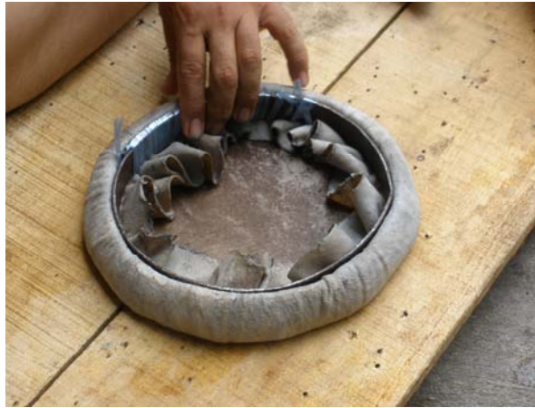
ภาพที่ 156 การนำขอบหุ้มหนังที่แช่น้ำแล้วกดเหล็กทับไว้
