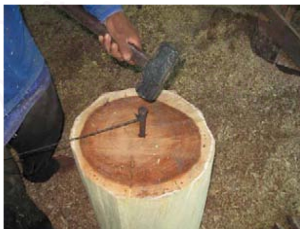
ภาพที่ 96 การใช้เหล็กตอกจุดศูนย์กลางก่อนกลึง
