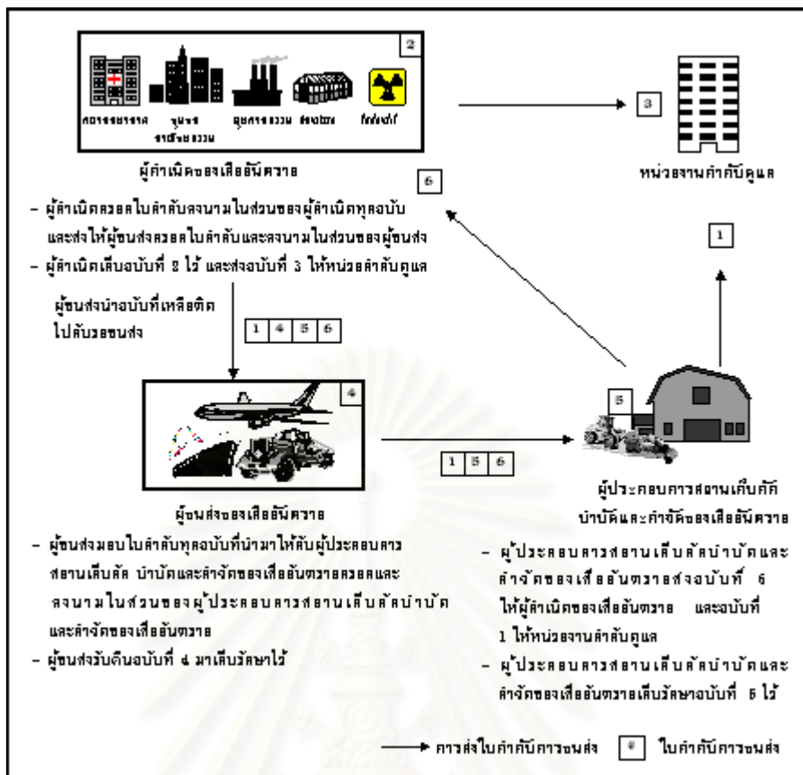
รูปที่ 2.1 ขั้นตอนการดำเนินการตามระบบเอกสารกำกับ การขนส่งของเสียอันตราย
