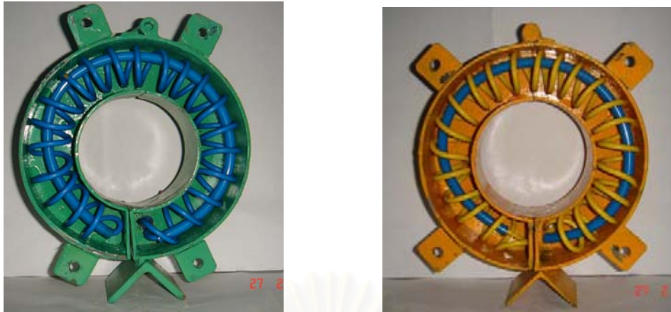
รูปที่ 3.4 : การพันขดลวด 2 ชุดตรงข้ามกัน
