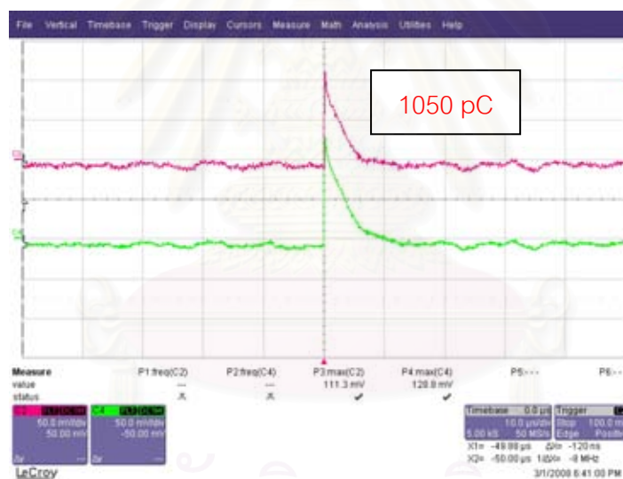
รูปที่ 4.12 : สัญญาณดิสชาร์จบางส่วนที่วัดได้จากโรกอฟ์ค็อยล์ RC1(เขียว) และ RC2(แดง) ที่แรงดัน Variac 180 V. หรือ แรงดันระบบ 6,136 V.
