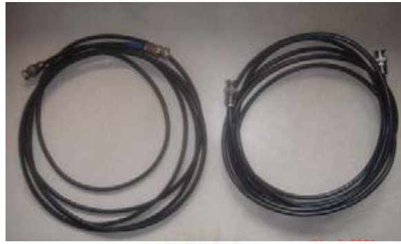
รูปที่ 3.16 : สายเคเบิลวัด 50 ohm หัวต่อ BNC
