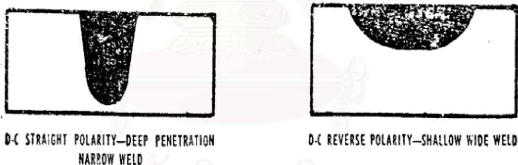
รูปที่ 2.20 แสดงภาพการซึมลึกของรอยเชื่อมระหว่างกระแสสลับกับกระแสตรง
