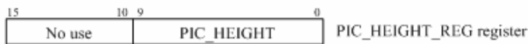
รูปที่ 3.120 การเรียงบิตของเรจิสเตอร์ PIC_HEIGHT_REG
