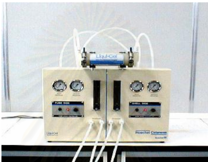
รูปที่ 3.1 อุปกรณ์ชุด Liqui-Cel ® Laboratory ที่ใช้ในการทดลอง
