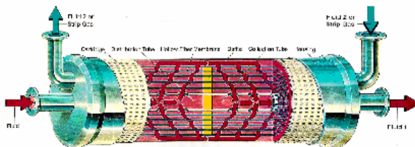
รูปที่ 3.2 ตัวรองรับชนิดเส้นใยกลวง Celgard ® x-30 240 Microporous Polypropylene Hollow Fibers
