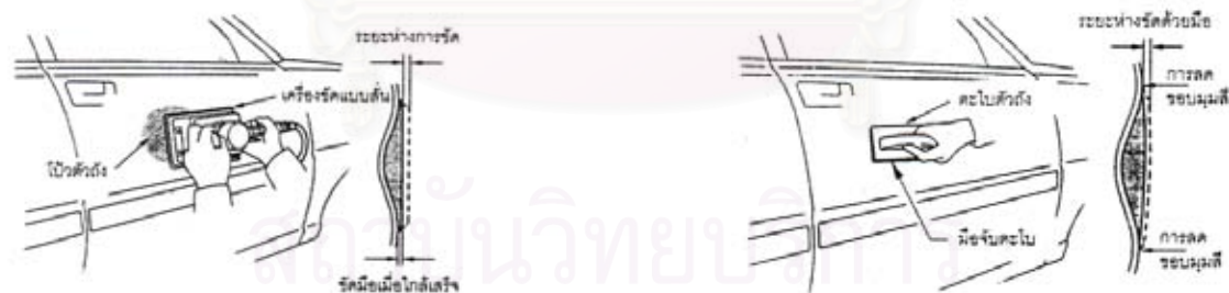
รูปที่ 1 แสดงการขัดสีโป้วโดย เครื่องขัดลม และบล็อกสำหรับขัดมือ
