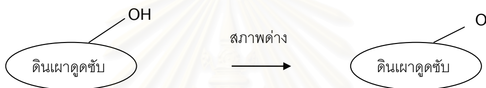
รูปที่ 4.20 การเกิดประจุลบบนผิวของดินเผาดูดซับในสารละลายต่าง
