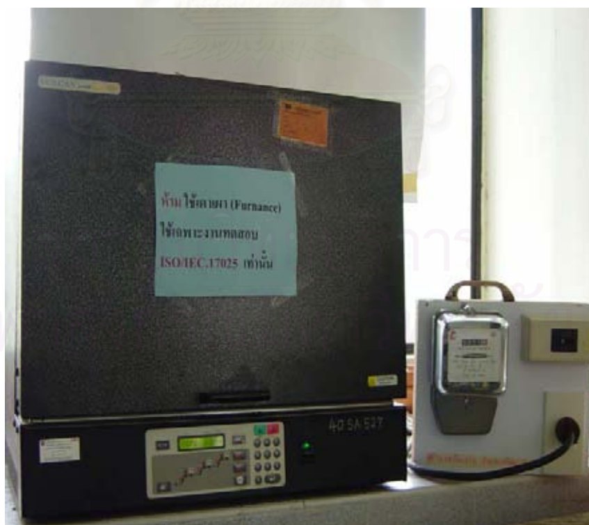
เตาเผาและอุปกรณ์วัดหน่วยไฟฟ้าที่ประกอบขึ้น
