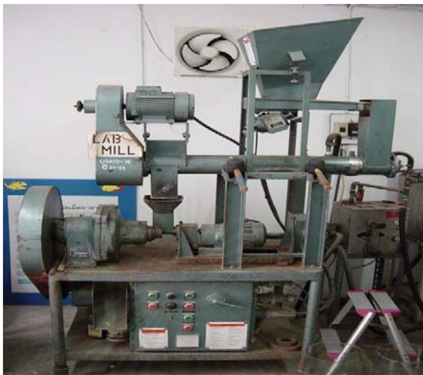
เครื่อง Pellet Mill สำหรับอัดเม็ดดินเผาอุตสาหกรรม
