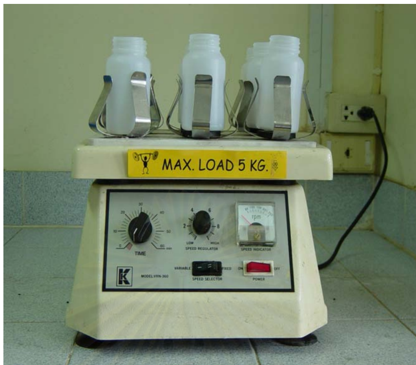
เครื่องเขย่าและขวด PE ขนาด 150 มิลลิลิตร ที่ใช้ในการทดลอง
